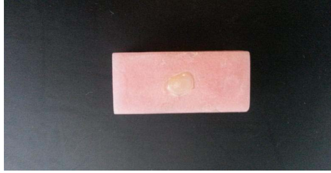
Resim 3. Yüzey mikrosertlik analizleri için mine örneklerinin akrilik bloklara yerleştirilme işlemi
