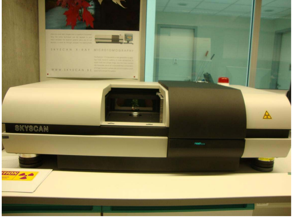
Resim 18. SkyScan 1172 yüksek çözünürlüklü mikro-CT (SkyScan, Belçika) cihazı
