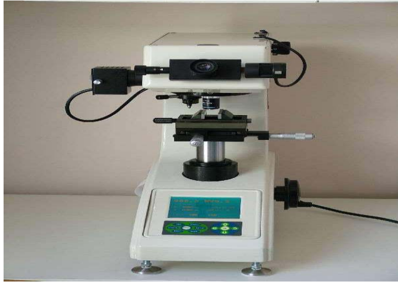
Resim 24. Yüzey mikrosertlik analizinde kullanılan Wilson Wolpert Micro-Vickers 401MVD (Aachen, Germany) cihazı
