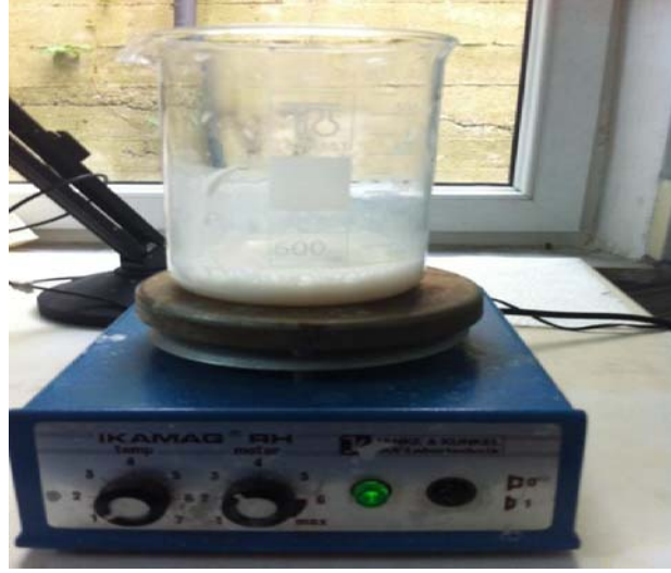
Resim 7. Manyetik karıştırıcı (IKAMAG RH, Janke & Kunkel IKA Labortechnik)
