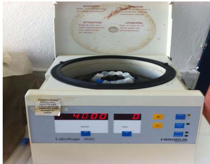
Resim 10. Santrifüj cihazına (Heraeus Sepatech Labofuge 200) macun karışımlarının yerleştirilmesi
