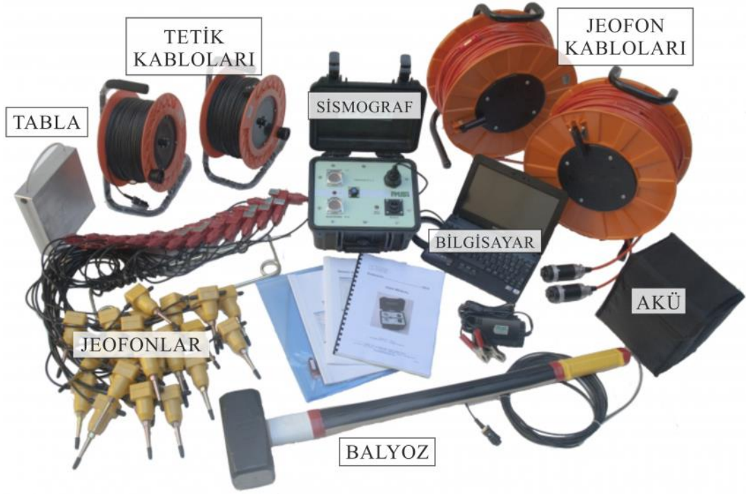
Şekil 4.6. MASW ve ReMi ölçüm ekipmanı
