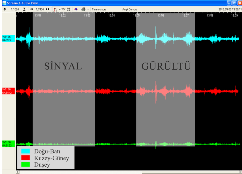
Şekil 4.5. Üç bileşenli mikrotremor kaydında, sinyal ve gürültü ayrımı
