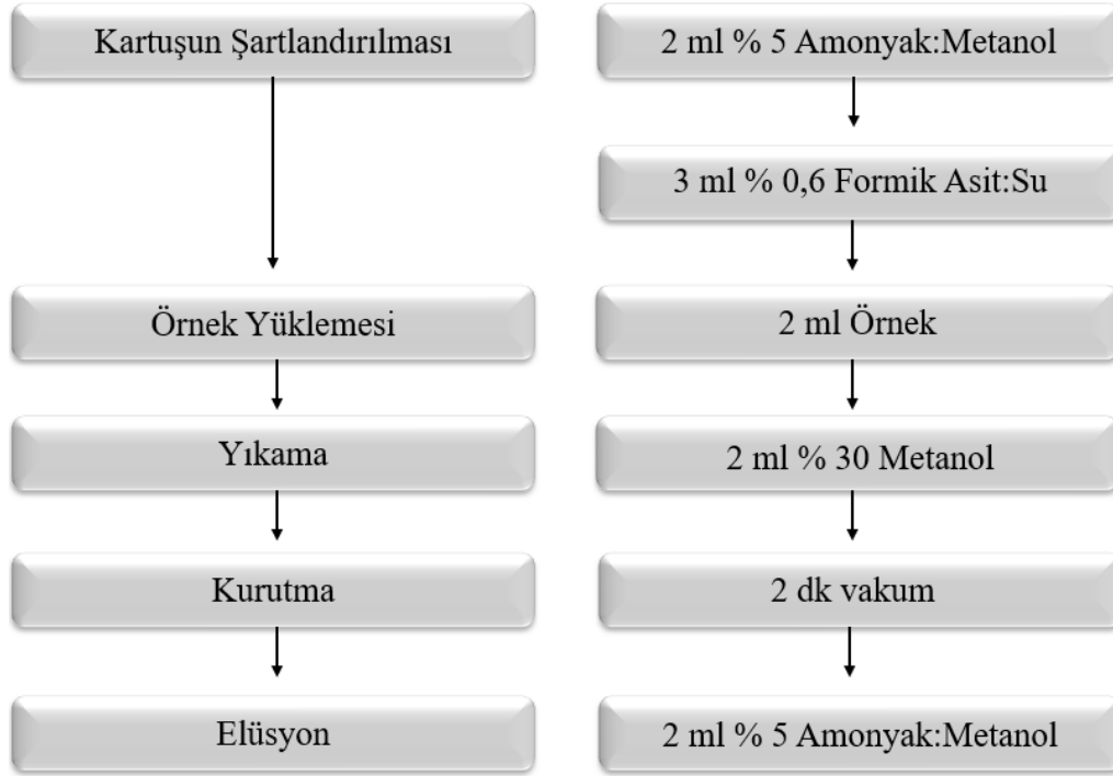
Şekil 3.2. Örneklerin katı faz ekstraksiyonu için gerçekleştirilen basamaklar
