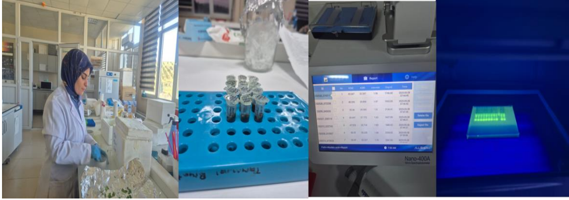
Şekil 3.11 Sırasıyla: sıvı azotla bitki dokusunun ezilmesi, RNA izolasyonu, Nanodrop cihazı ile RNA saflık ve yoğunluk ölçümü, UV altında RNA görüntülemesi
