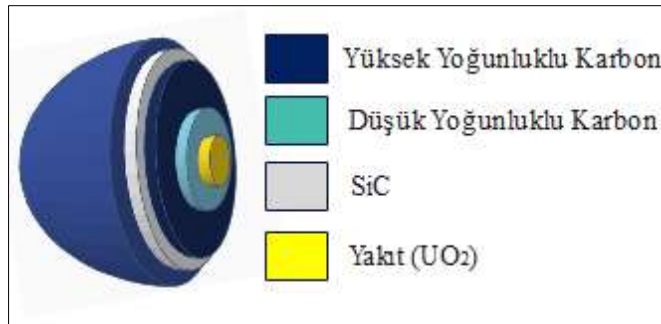
Şekil 3.2 TRISO yapısının genel gösterimi [40]
