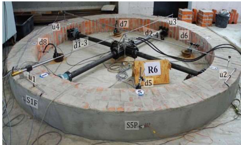
Şekil 2.9 Tarihi Yapı Kubbesi Üzerinde Yapılacak Çalışma İçin Hazırlanan Deney Düzenegi (Jasieńko, J., vd.)
