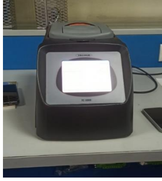
Şekil 3.3. cDNA sentezinde kullanılan Techne TC- 5000 Thermal Cycler cihazı
