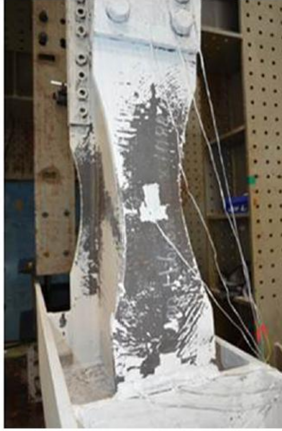
Şekil 6.56 (devam): Deney numunesi ile sonlu eleman modelinin şekil değiştirmiş durumlarının karşılaştırılması.
