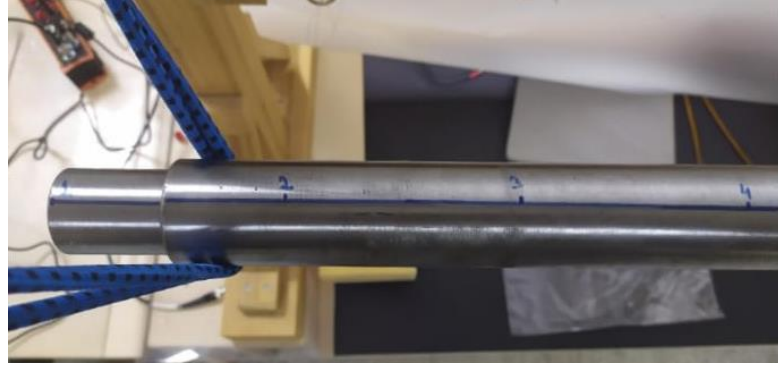
Şekil 3.17. Mil üzerinde çekiç vuruş noktaları.
