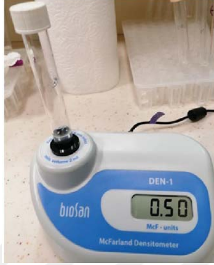
Şekil 2.3. İzolatların McFarland cihazında 0,5 bulanıklık derecesine ayarlanması
