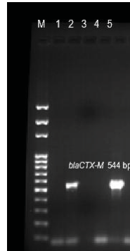
Şekil 3.6. E. coli izolatlarının PZR ile GSBL genlerinden bla CTX-M genlerinin elektroforez görüntüsü. M: Marker (100 bp); 2 ve 5. Sütunlar pozitif; diğer sütunlar negatif.
