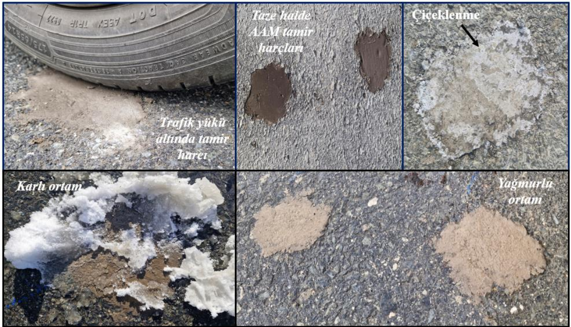
Şekil 4.46 Trafik yükleri ve dış etkiler altında AAM tamir harçları
