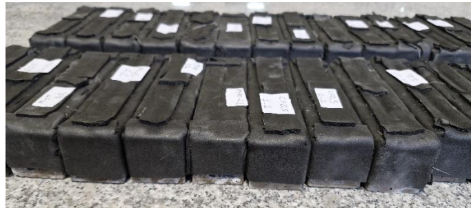
Şekil 3.12 Buz çözücü tuzlar içeren donma ortamına hazırlanan tamir harçları
