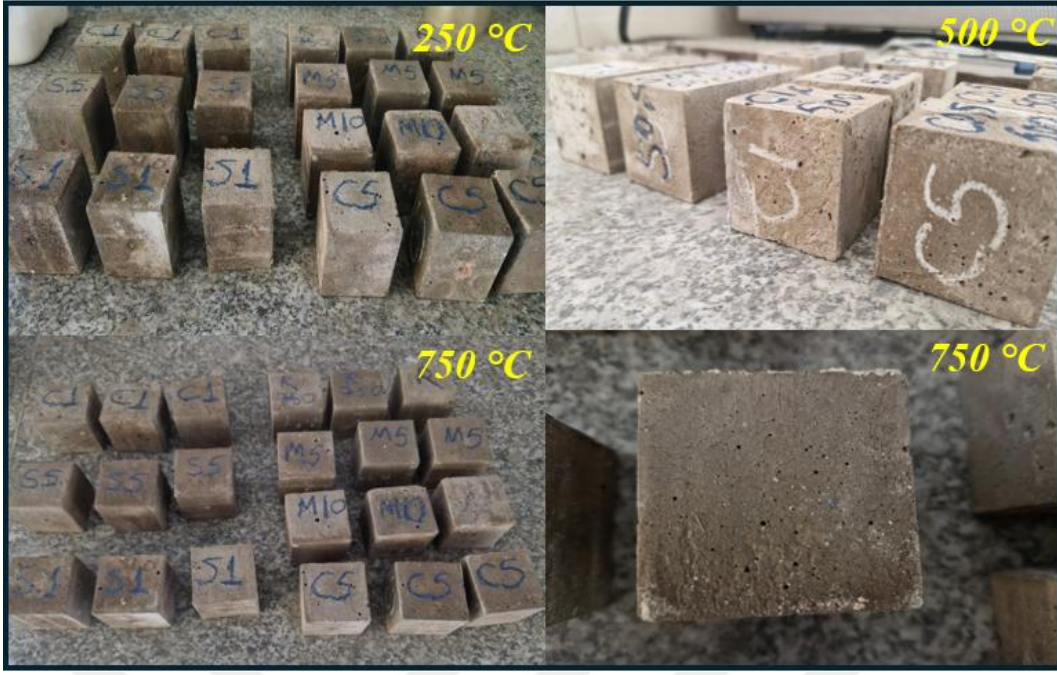
Şekil 4.41 Yüksek sıcaklık sonrası tamir harcı numunelerinin fiziksel görünümü
