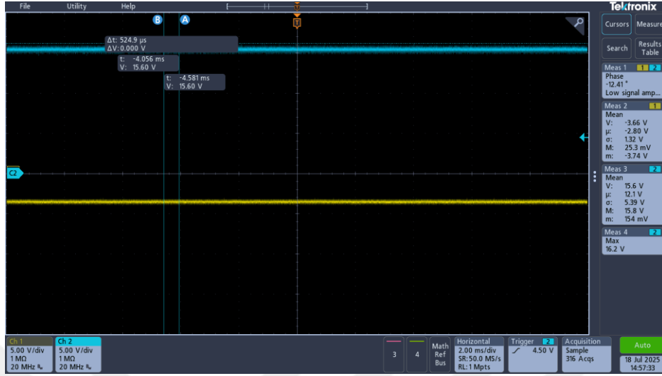
Şekil 4.6 Flyback topolojili GDPS’in tam yük altında çıkış gerilimleri
