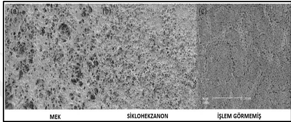
Şekil 5.1: Kullanılan non-solvent tipi ile yüzey morfolojisindeki değişimi gösteren SEM görüntüleri, (a) 750x büyütmede MEK, (b) 750x büyütmede sikloheksanon ve (c) 1000x büyütmedeki muamele edilmemiş PP membran.
