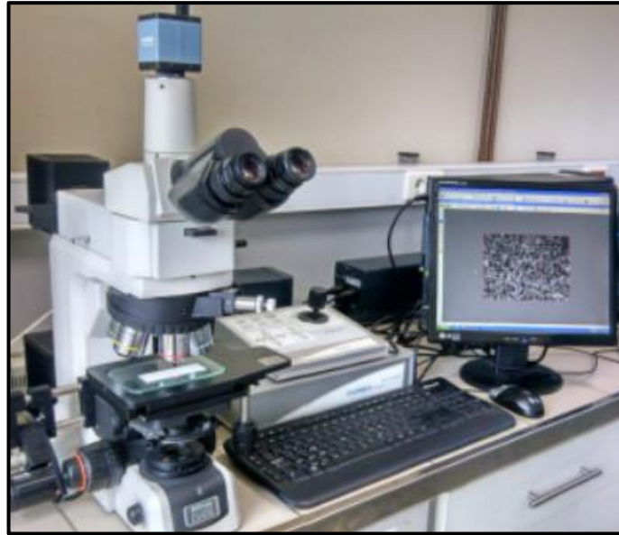
Şekil 6.9: Nikon Eclipse LV 100 Optik Mikroskop.
