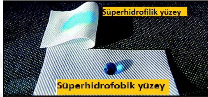
Şekil 3.1: Hidrofilik (su seven) ve süperhidrofobik (su sevmeyen) kumaş yüzeyleri.
