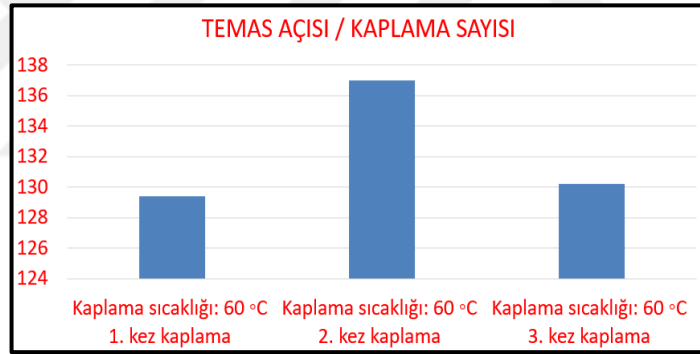
Şekil 7.1: 50 mg/ml ve %17 non-solvent oranına sahip COC polimeri çözeltisi kaplama sayısı-temas açısı grafiği.
