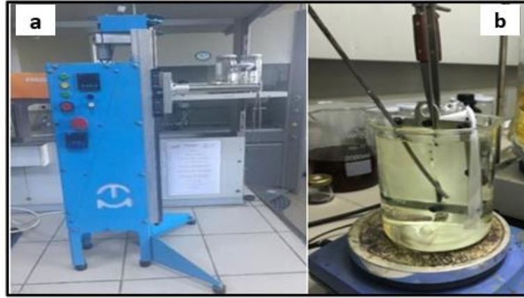
Şekil 6.5: Daldırma cihazı ve daldırma prosesi görselleri, a) Daldırma cihazı görseli b) Daldırma prosesi görseli.
