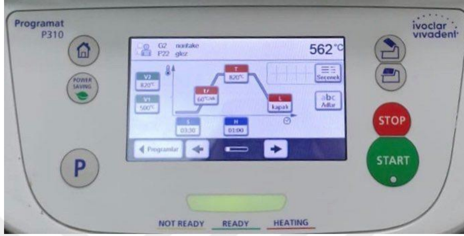
Şekil 3.8. Celtra Duo için fırınlama görüntüsü
