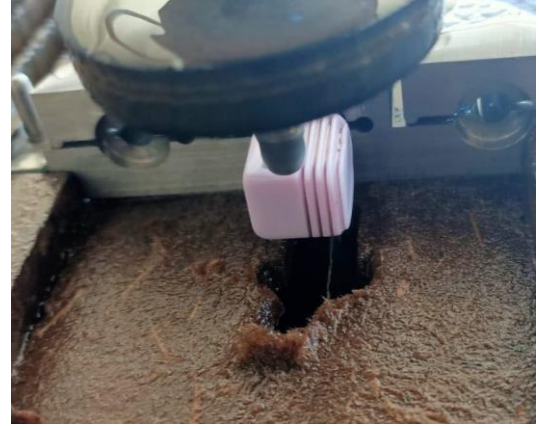
Şekil 3.6. IPS e.max CAD blokların su jet cihazında kesimi
