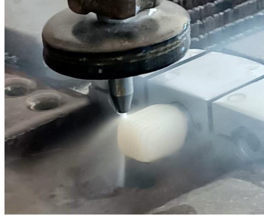
Şekil 3.5. Celtra Duo blokların su jet cihazında kesimi
