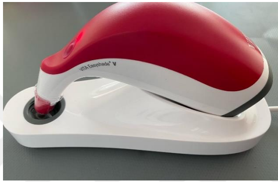
Şekil 3.26. Spektrofotometre cihazının kalibrasyonunun yapılması
