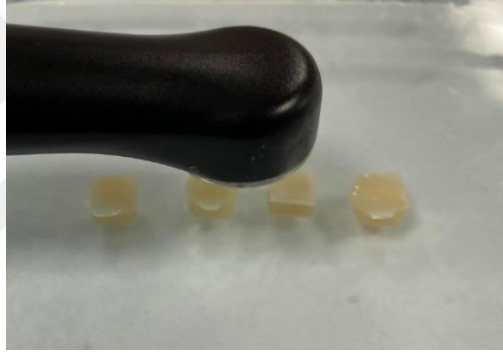
Şekil 3.21. Rezin siman uygulanmış örneklerin ışık cihazıyla polimerizasyonu
