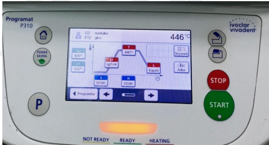
Şekil 3.9. IPS e.max CAD için fırınlama görüntüsü
