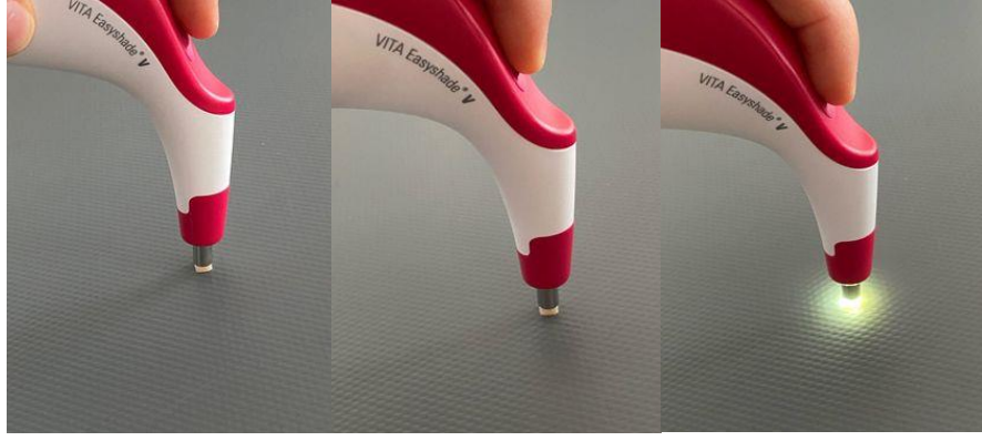
Şekil 3.25. Gri arka plan üzerinde örneklerin renk ölçümünün yapılması
