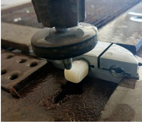
Şekil 3.5. Celtra Duo blokların su jet cihazında kesimi
