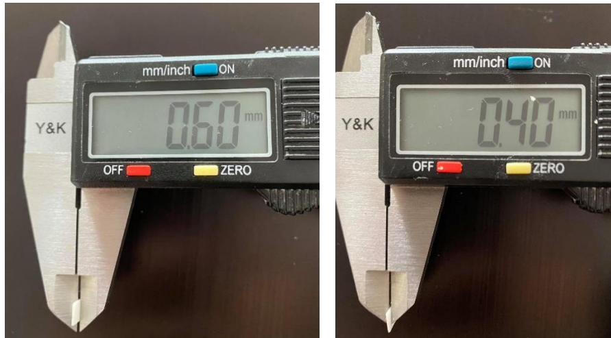
Şekil 3.10. Örneklerin kalınlığının dijital kumpas ile kontrol edilmesi
