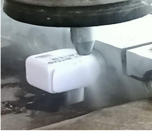
Şekil 3.6. IPS e.max CAD blokların su jet cihazında kesimi
