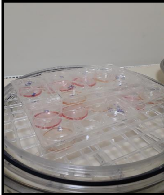
Resim 7. Wound healing testi için hipoksi ortamına alınacak 6’lı plakaların modüler inkübatör chamber içine yerleştirilmesi.
