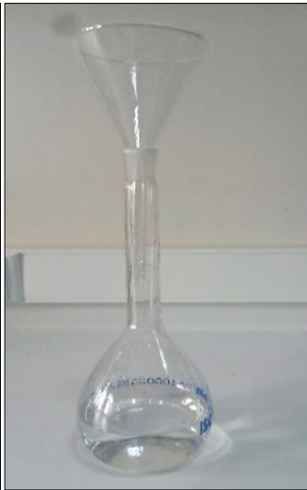
Şekil 11. Saf K_2Cr_2O_7 ile Saf (NH_4)_2 Fe (SO_4)_2 6H_2O 'nun Saf Su İle Distile Edilmesi
