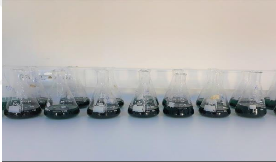
Şekil 18.Titrasyon İşlemi Sonrasında Brillant Yeşil Renge Dönen Çözelti
