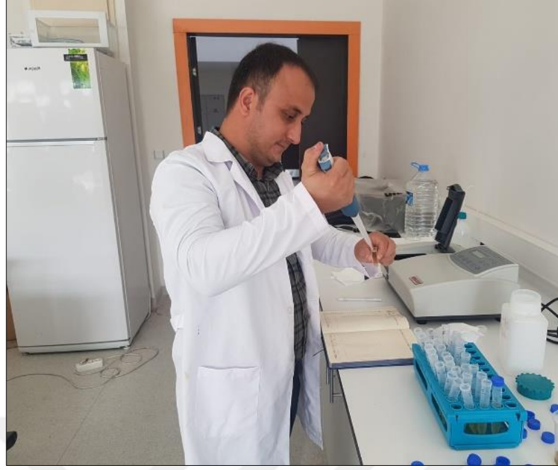
Şekil 22. Aseton Çözeltilisinin Spektrofotometre Küvetleri İçerisine Yerleştirilmesi
