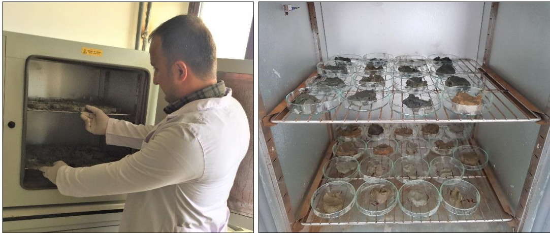
Şekil 8. Örneklerin Etüve Yerleştirilmesi ve 24 Saat 60^{\circ}\text{C} 'de Kurutma İşlemi
