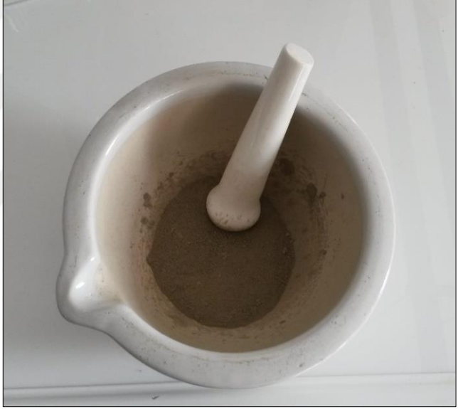
Şekil 10. Örneklerin Porselen Havanda Dövülerek Toz Haline Getirilmesi
