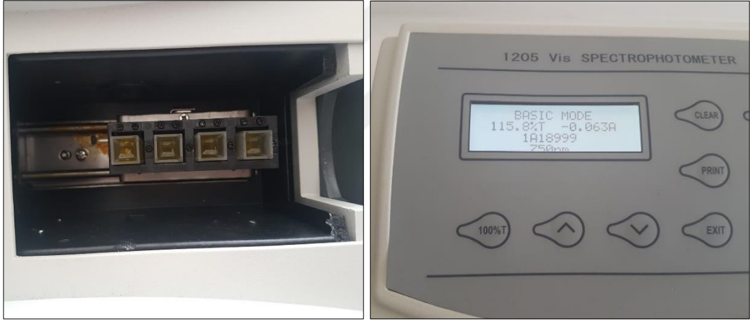
Şekil 23. Spektrofotometre Küvetlerine Doldurulan Çözeltilinin 667 ve 750 nm’de Okunması
