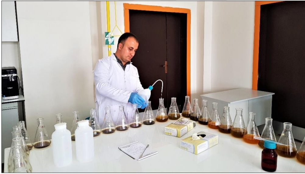
Şekil 16. Erlen İçerisindeki Çözeltinin Saf Su ile 200 ml Seviyesine Seyreltilmesi
