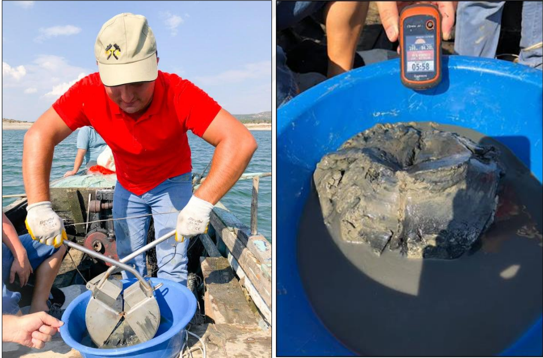
Şekil 7. Yüzey Çökelinin Grab'ten Çıkarılması ve Yaş Halinin Görüntüsü
