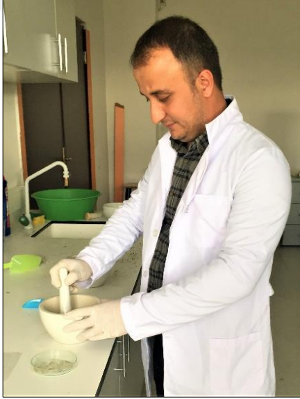
Şekil 10. Örneklerin Porselen Havanda Dövülerek Toz Haline Getirilmesi
