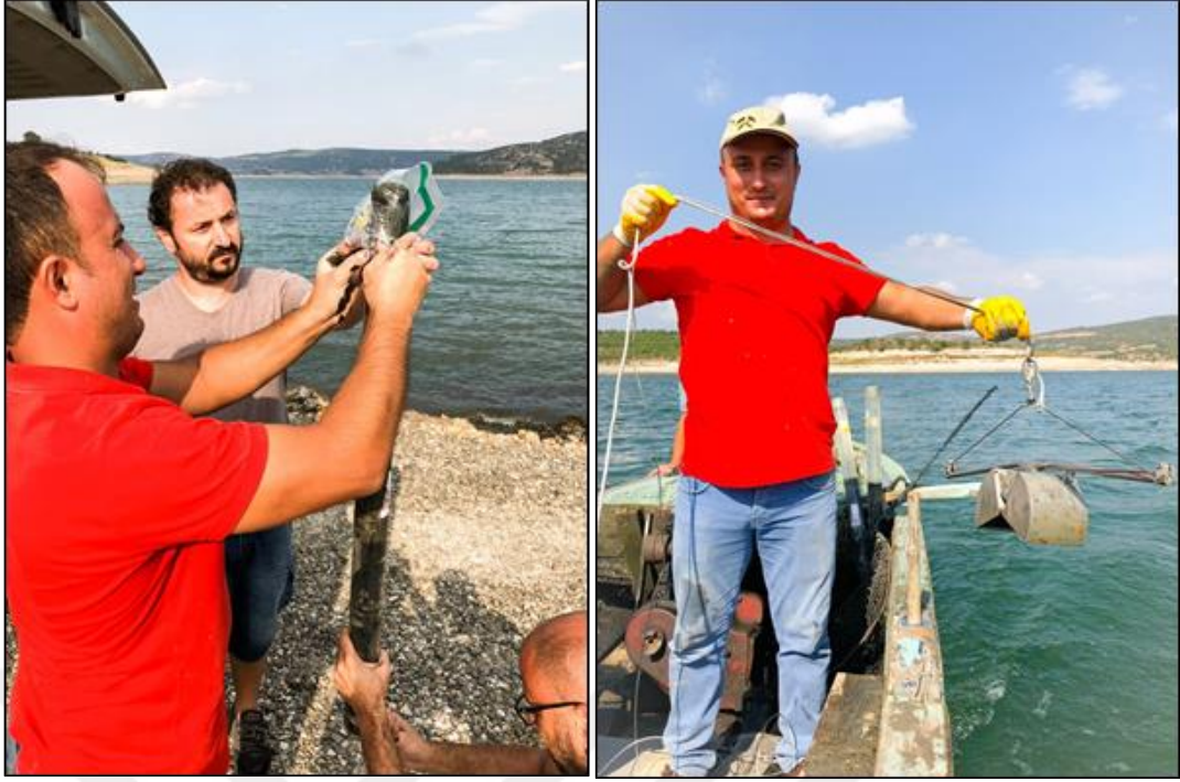
Şekil 6. Karotun Dilimlenmesi ve Yüzey Çökeli Almak İçin Van Veen Grab'ın Suya Bırakılması
