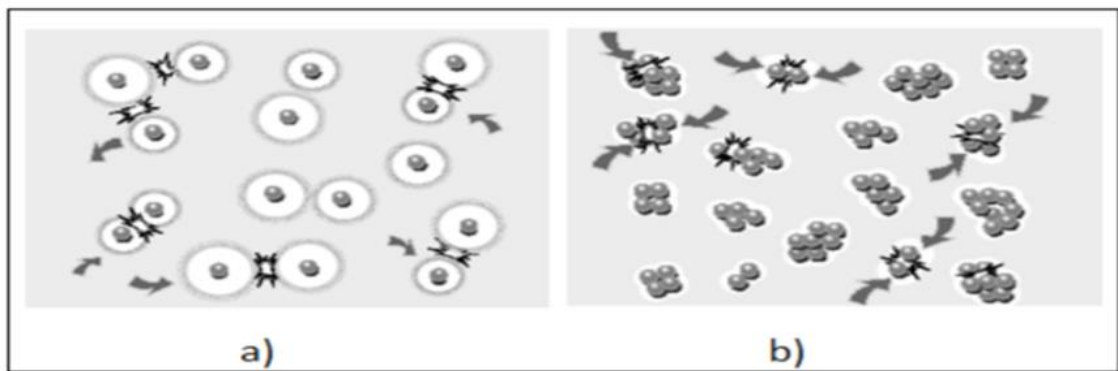
Şekil 3. 2 (a) Yüklü tanecikler birbirini itmektedir ve (b) Yüksüz tanecikler yumaklı Bir yapı oluşturmaktadır (Filibeli, 1996)
