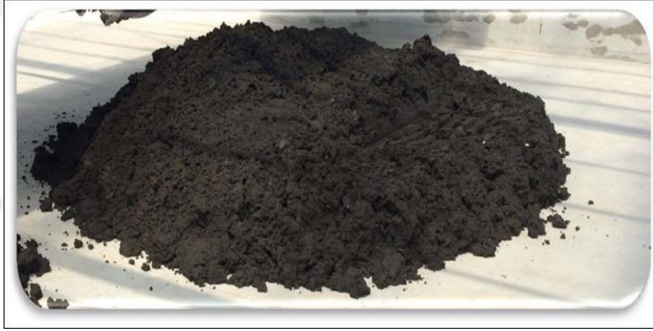
Şekil 3. 1. Arıtma çamuru örneği (Yıldız vd, 2009)
