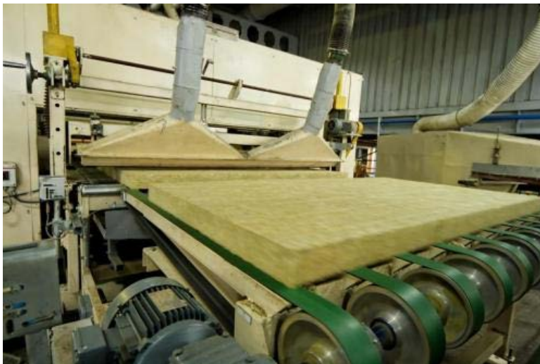
Şekil 5.14: Taş yünü malzemesinin uygun formatlarda kesilmesi [51]
