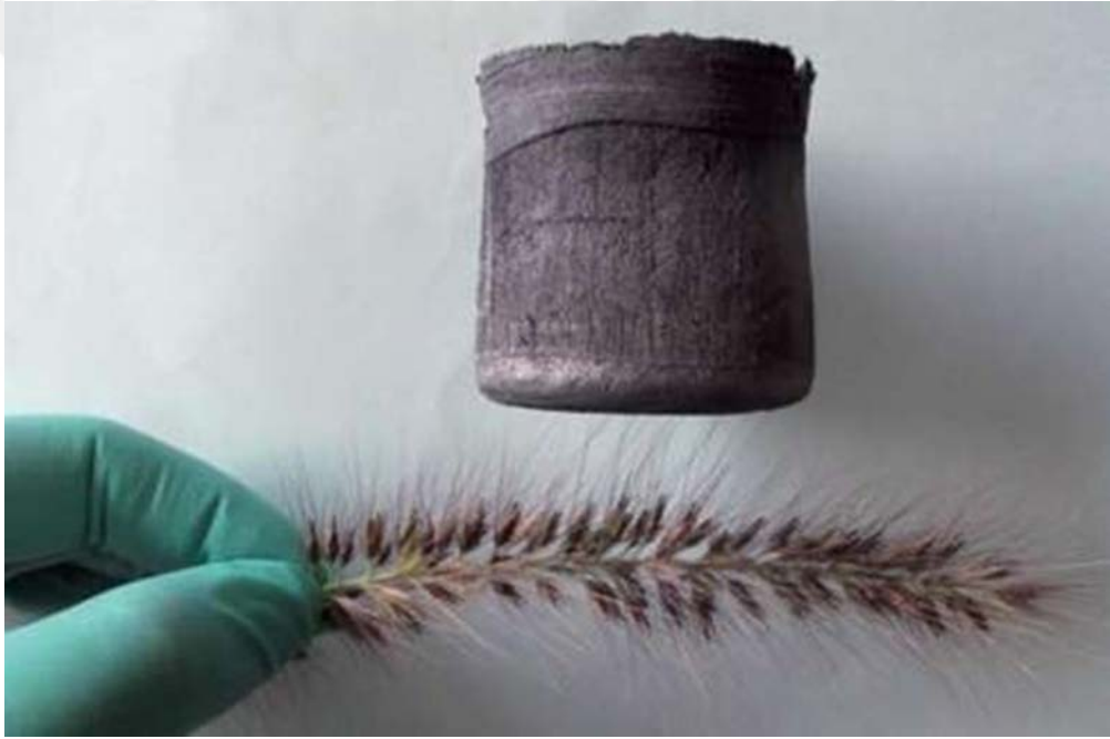
Şekil 4.11: Grafen aerogel bilinen en hafif katı malzeme [40]
