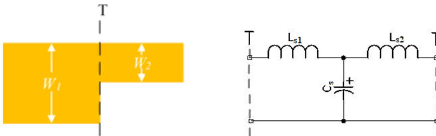
Şekil 13. Mikroşerit basamak süreksizliği ve eşdeğer devresi
