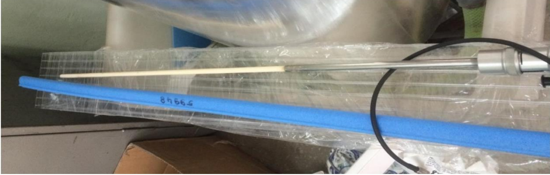
Resim 5.7. Seramik uçlu gaz probu
