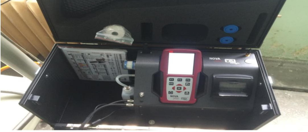
Resim 5.6. Taşınabilir baca gazı analizörü
