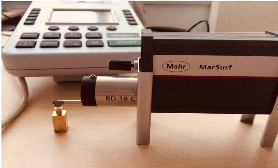
Resim 3.8. Profilometre cihazı ile yüzey pürüzlülüğü ölçümü
