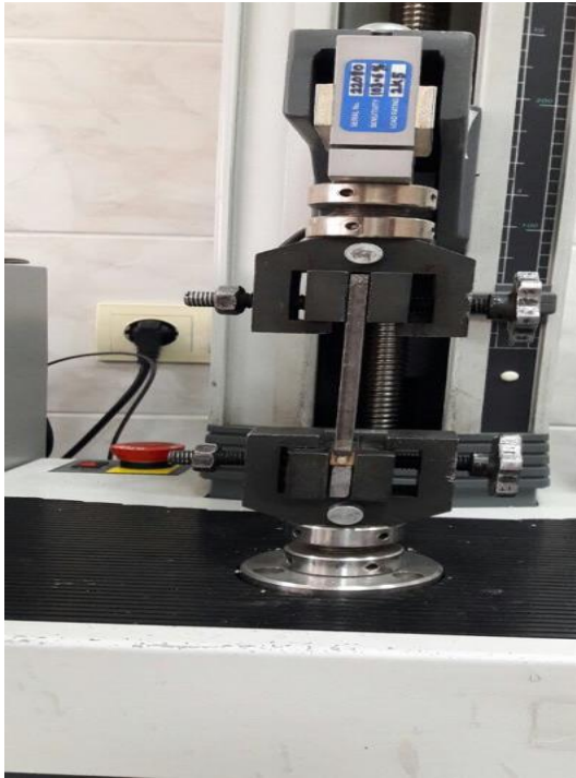
Resim 3.12. Evrensel test cihazı
