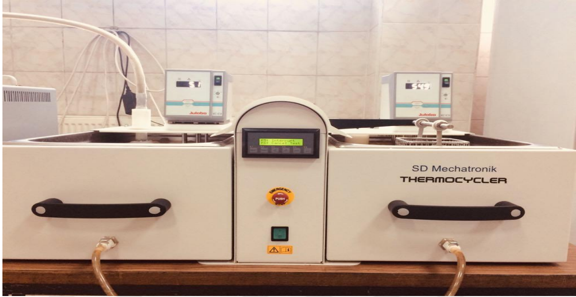
Resim 3.14. SD Mechatronik termal yaşlandırma cihazı
