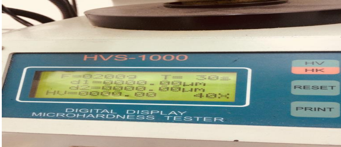
Resim 3.9. HVS-1000 mikrovickers sertlik ölçümü cihazı ve çalışmada kullanılan parametreler
