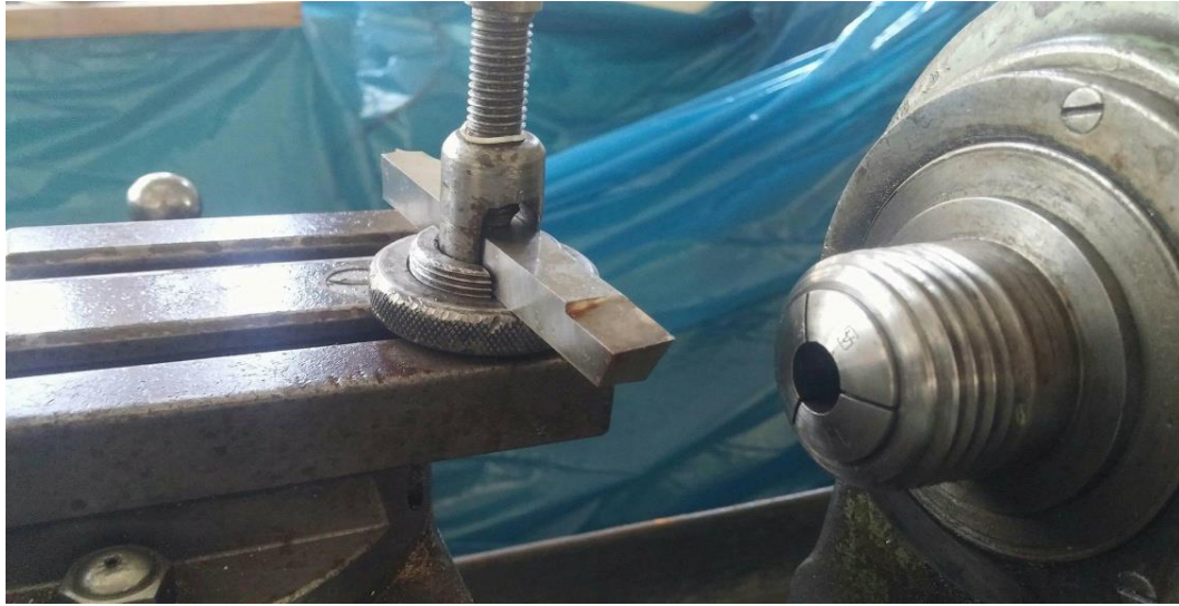
Resim 3.3. Masa tipi saatçi tornası ve hava çeliği kalemi
