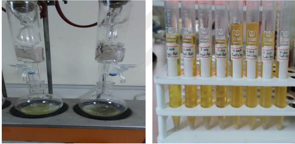
Şekil 3.14. Yağ analiz cihazında (sokshalet) ekstraksiyon işlemi ve yağ analiz cihazında elde edilen yağlar
