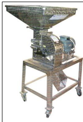
Şekil 4.1. Çekiçli değirmen öğütücü (Brook Crompton 2000, ENGLAND)
