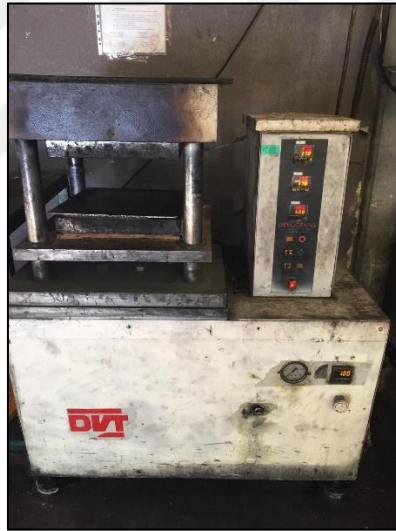
Şekil 4.8. Laboratuvar tipi pişirme presi (Devotrans A-130)
