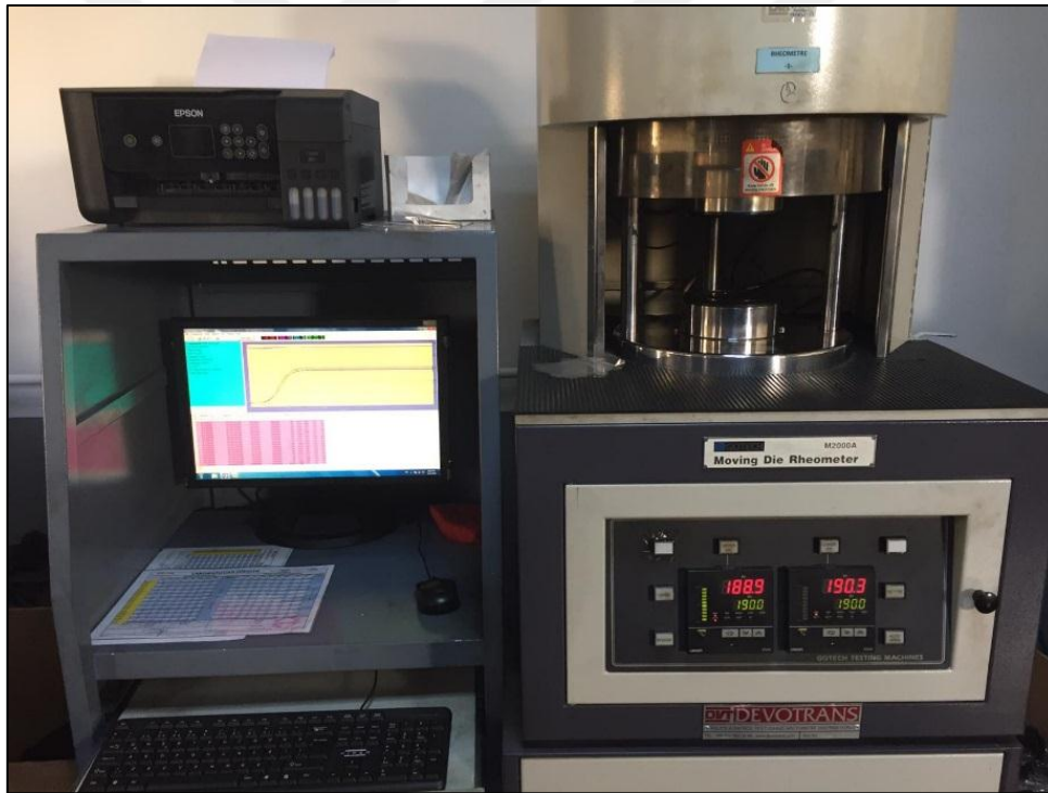
Şekil 4.5. Devotrans M2000-A MDR (Moving Die Rheometer) tipi reometre cihazı
