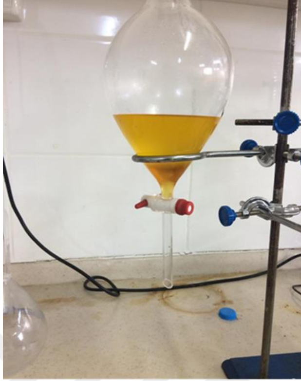
Şekil 4.7. Transesterifikasyon sonrası faz ayrışımı
