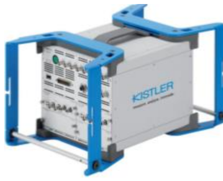
Şekil 4.17. Veri toplama cihazı (Kistler KiBox)
