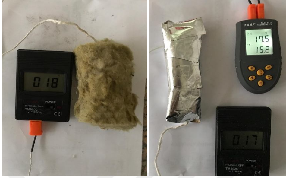
Şekil 4.13: Taş yünü ile kaplanmış FRP kompozit.
