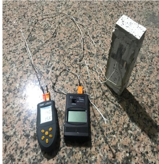
Şekil 4.16: Alçı kaplı taş yünü ile kaplanmış FRP kompozit.
