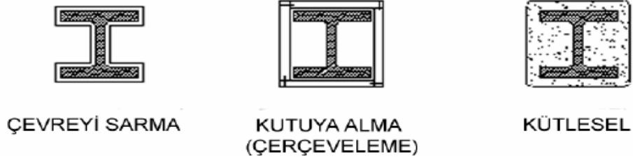
Şekil 3.9: Yangın yalıtımı için kullanılan uygulamalar [81].
