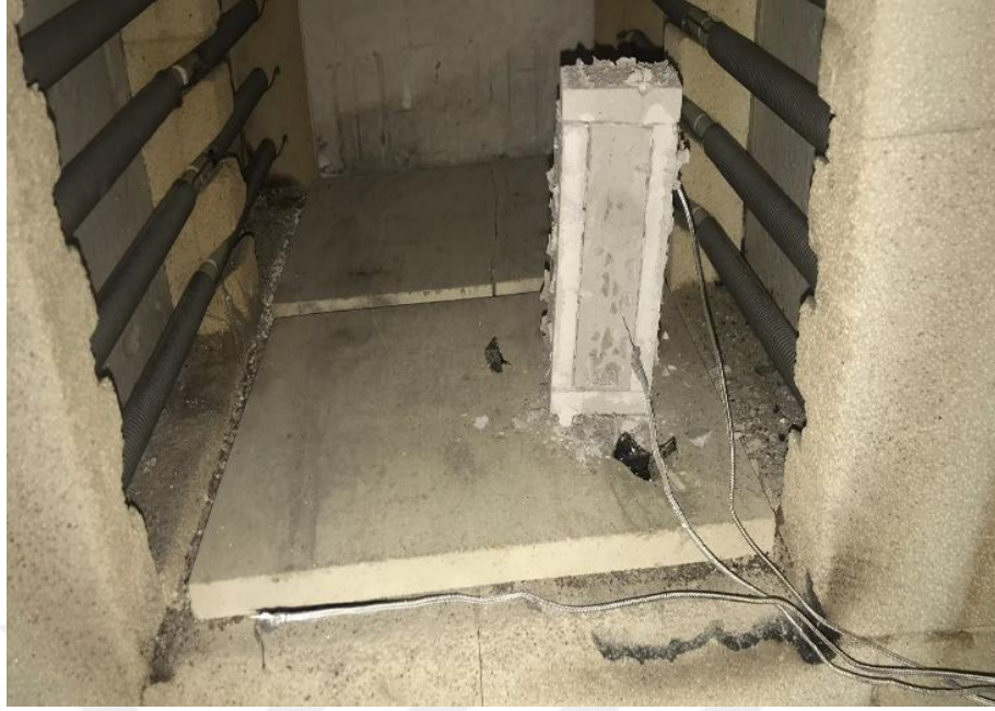
Şekil 4.4: Deney sonrası alçıpan ile korunmuş FRP kompozit.
