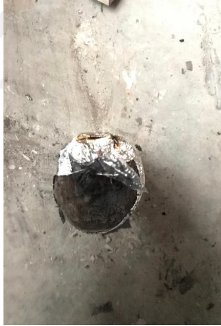
Şekil 4.14: Deney sonrası taş yünü ile kaplanmış FRP kompozit.
