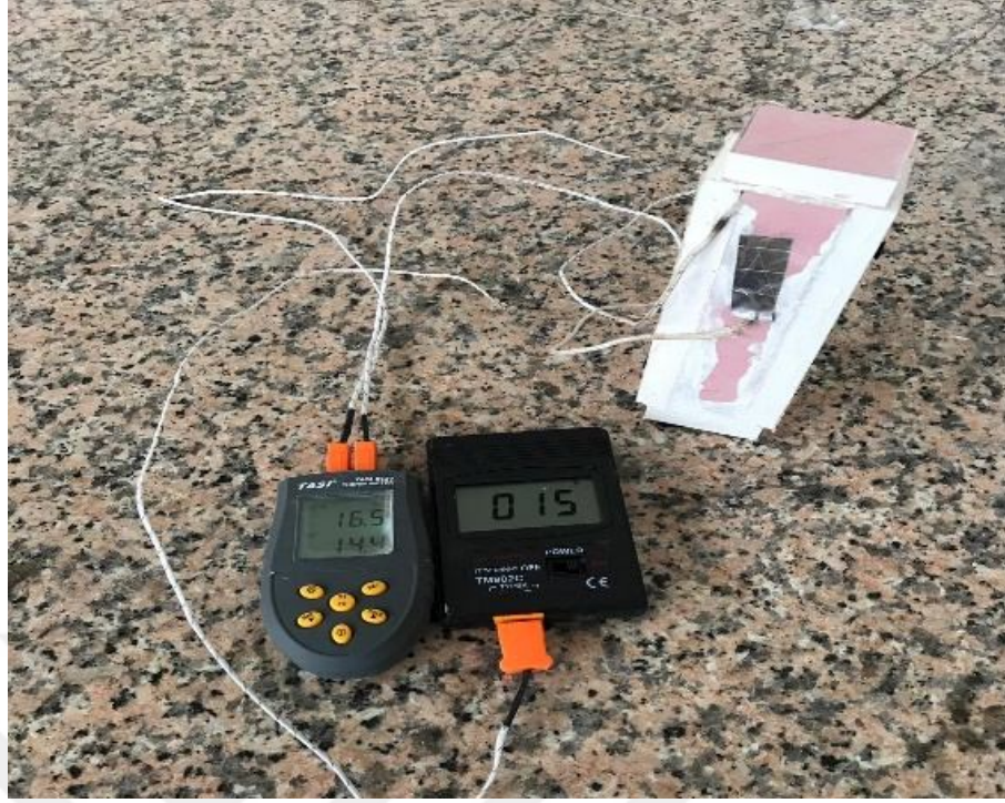
Şekil 4.7: Kırmızı alçıpan ile kaplanmış FRP kompozit ve prob bağlantıları.
