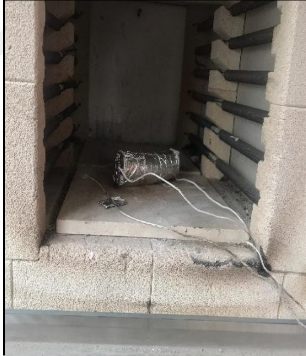
Şekil 4.11: Deney sonrası seramik yünü ile kaplanmış FRP kompozit.
