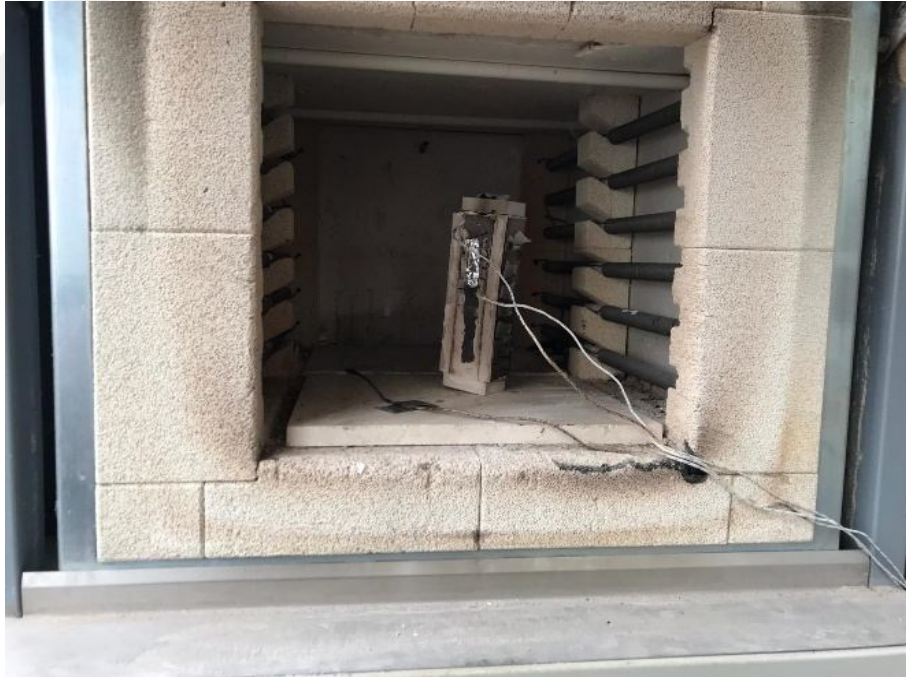
Şekil 4.8: Deney sonrası kırmızı alçıpan ile kaplanmış FRP kompozit.
