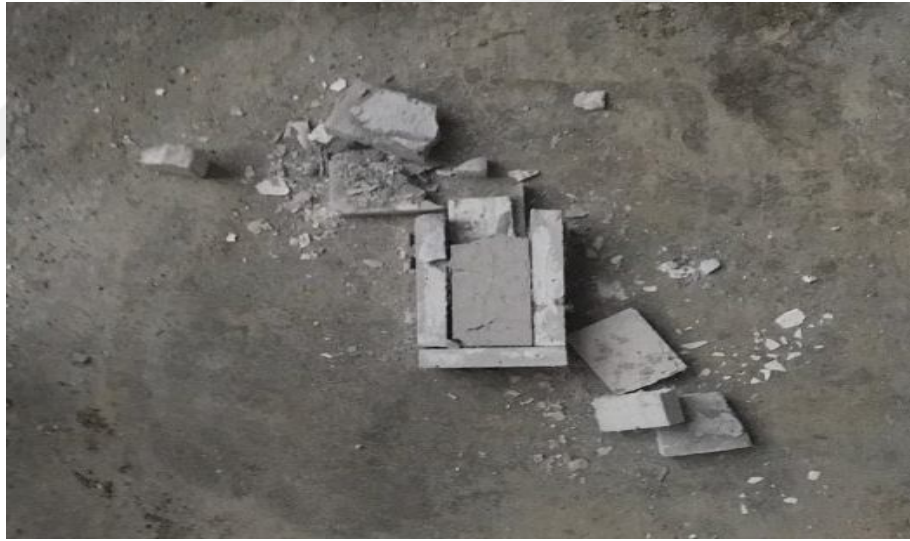
Şekil 4.5: Fırından çıkarılmış alçıpan ile korunmuş FRP kompozit.
