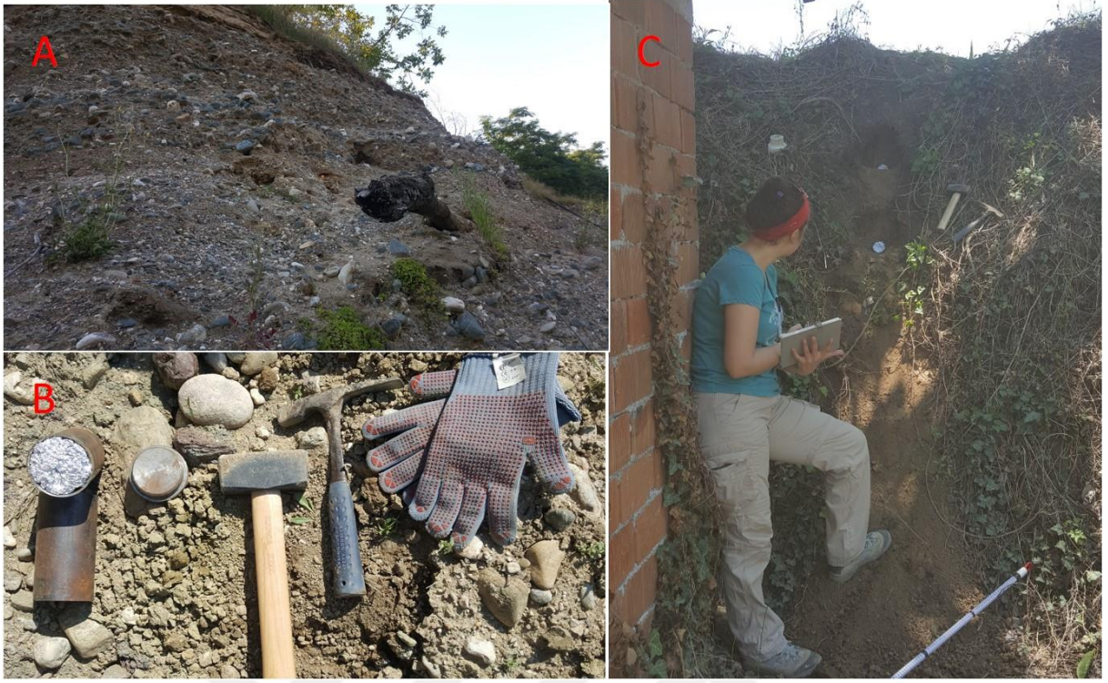
Şekil 22: A. 14C yöntemi ile yaşlandırılan yatak yükü içerisindeki ağaç kütüğü, B. Lüminesans örnekleme araçları, C. OSL Örnekleme sürecinde ölçekli kesit çizimi.
