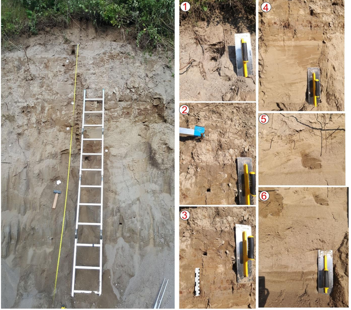
Şekil 34: Yukarı Kirazca Mahallesi yakınlarındaki A kesiti, T2 taraça basamağında yer alır. 1 den 6'ya kesit tavanından tabanına belirgin fasiyes değişimlerinin görünümü.
