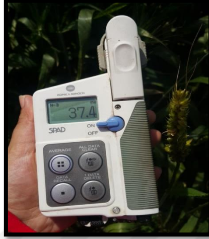
Şekil 3.10. Taşınabilir klorofilmetre ölçüm aleti (Minolta SPAD-502)
