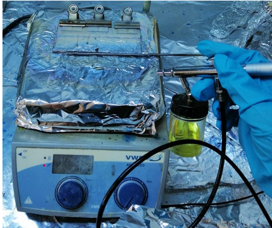
Şekil 3.4 TiO 2 kaplamada kullanılan püskürtme yöntemi
