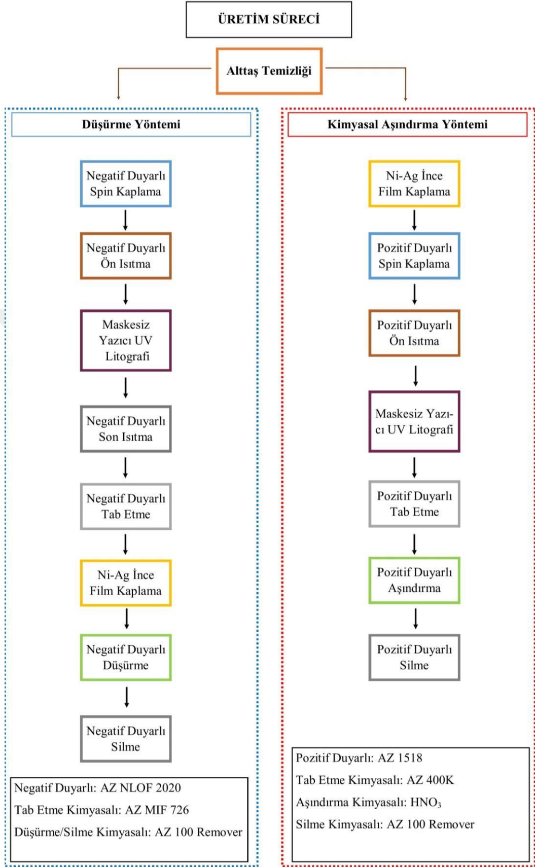
Şekil 4.5'te Foton eleği üretim süreci düşürme ve ıslak kimyasal aşındırma yöntemleri işlem akış şeması.
