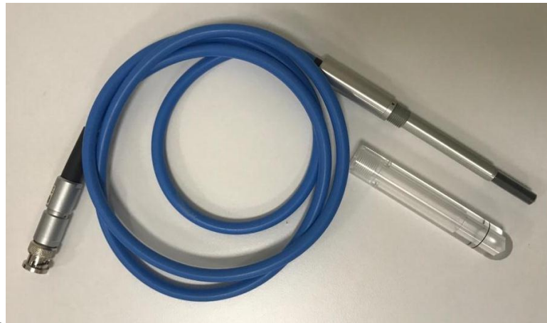
Şekil 3.17. Çalışmada kullanılan PTW 30013 0,6 cc silindirik iyon odası.
