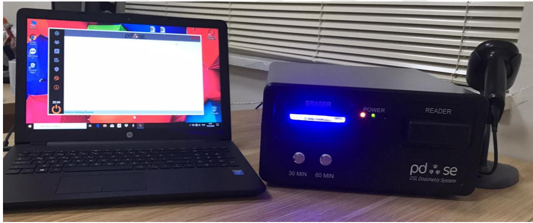
Şekil 3.18. Çalışmada kullanılan Pdose lüminesans ölçüm sistemi.
