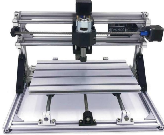
Şekil 3.7. Çalışmada kullanılan kartezyen robot (lineer kızak sistemi).
