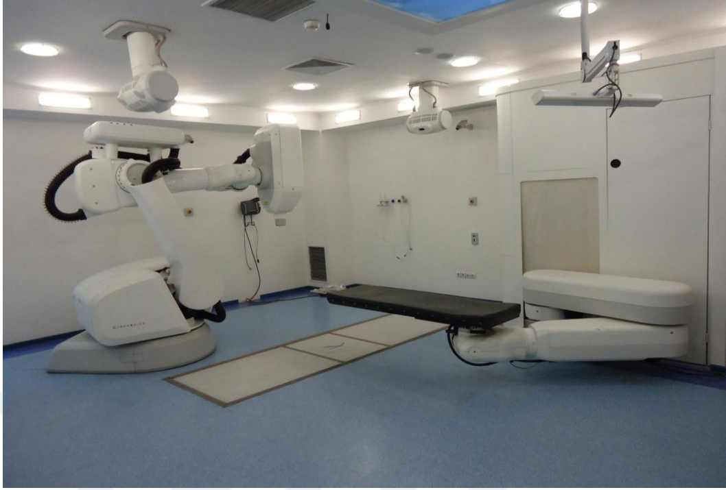
Şekil 3.1. CyberKnife® robotik radyocerrahi sisteminin genel görüntüsü.
