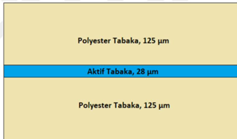
Şekil 3.12. Çalışmada kullanılan Gafkromik EBT3 filmlerin katmanları.
