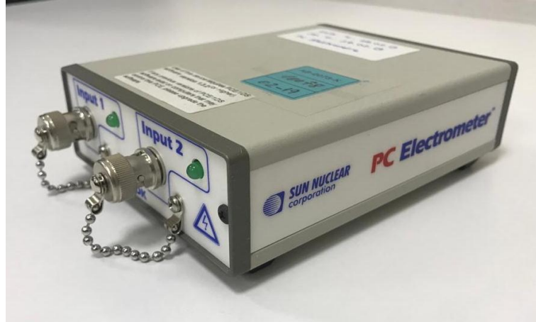
Şekil 3.16. Çalışmada kullanılan Sun Nuclear® elektrometre.
