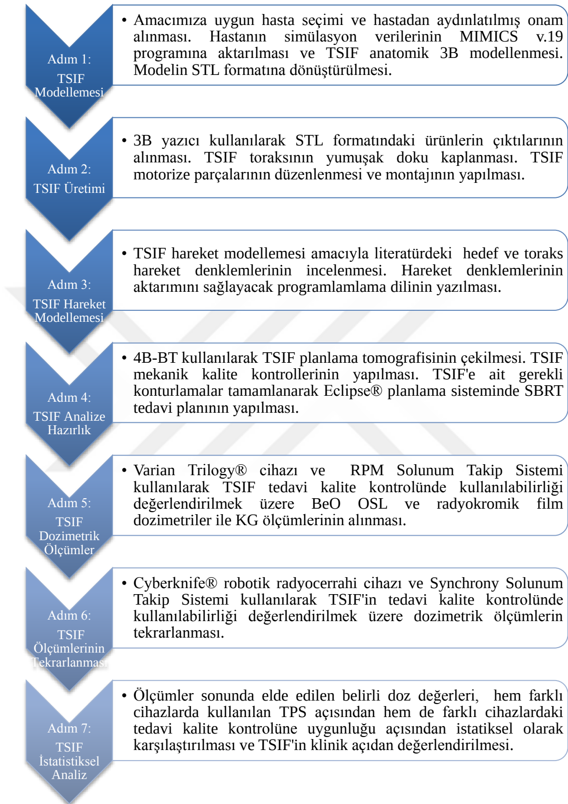
Şekil 3.20. Çalışmaya ait iş-akış şeması gösterilmektedir.
