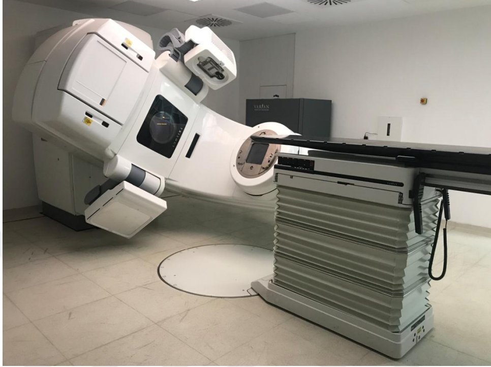
Şekil 3.2. Trilogy® radyoterapi sisteminin genel görüntüsü.
