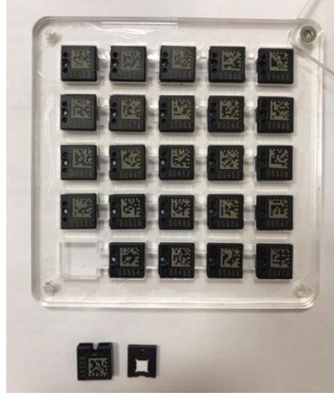
Şekil 3.19. Çalışmada kullanılan BeO kristali, ışıktan koruyucu kutu, 2D barkod ve seri numarası örnekleri.
