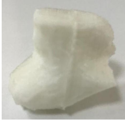
Şekil 3.27. STH filament ile baskısı yapılmış hastaya özgü ITV çıktısı.
