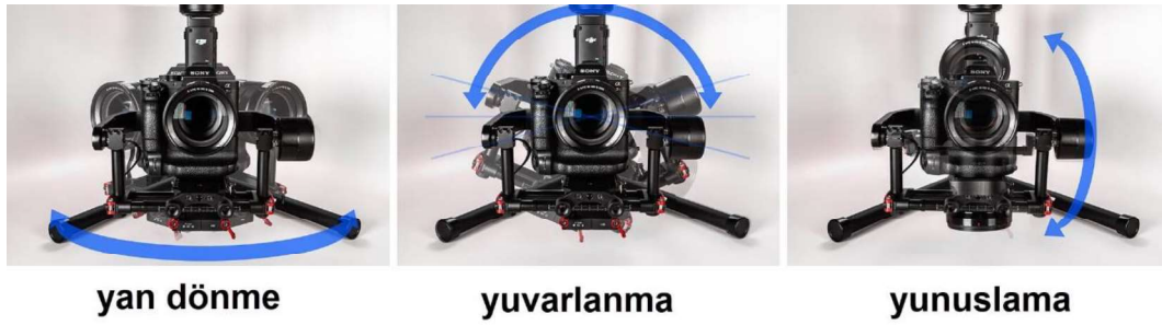
Şekil 1.4. Stabilize platformun dönü eksenleri (Soule, 2018)
