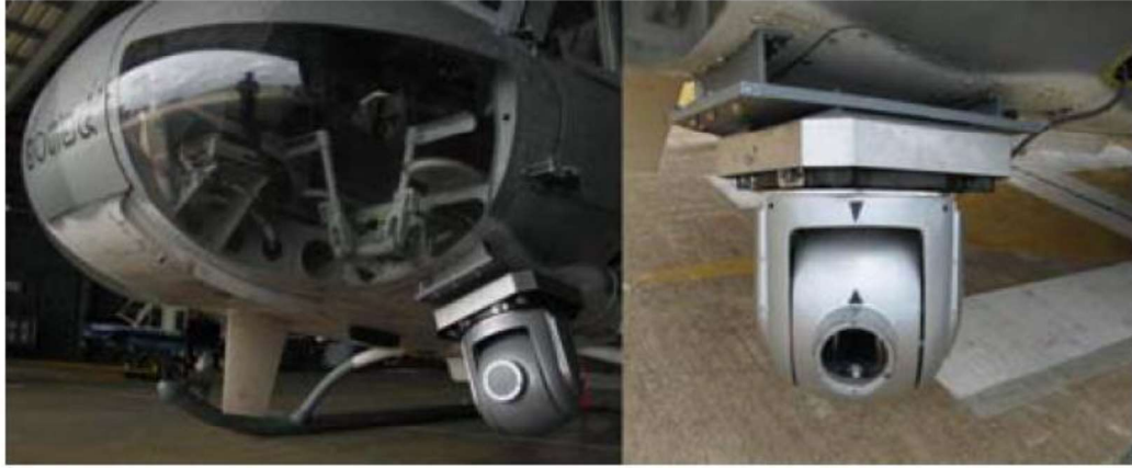
Şekil 2.7. Helikoptere monte 2 eksenli kardan platformu
