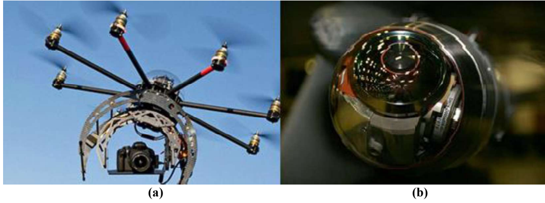
Şekil 1.3. İnsansız hava aracında stabilizasyon (a), bir füzenin stabilizasyon yapan arayıcı başlığı (b)
