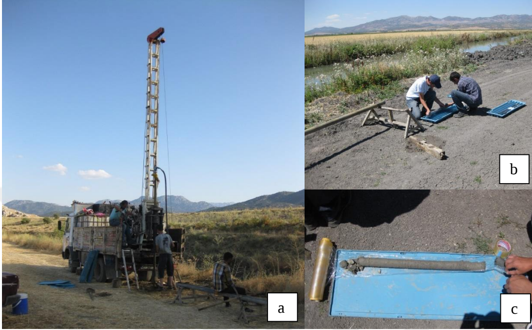
Şekil 3.1 Suğla Gölü çevresinde gerçekleştirilen sondajlardan bazı görüntüler: a) SK 1 sondajı yapılırken; b) Alınan karotların loglanması; c) 50 mm çaplı karotiyerle alınan karotlardan örnek
