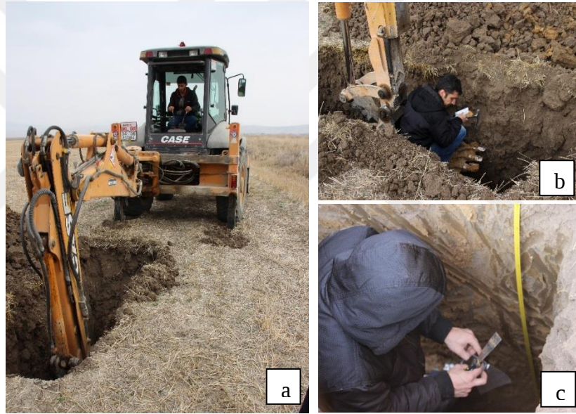
Şekil 3.2 Araştırma çukuru çalışmasından bazı görüntüler: a) Kepçe ile 1 m genişlikte, 3 m derinlik ve 5 m boyundaki çukurun açılması; b) ve c) Çukurun değişik metrelerinde cm düzeyinde loglama ve örnekleme
