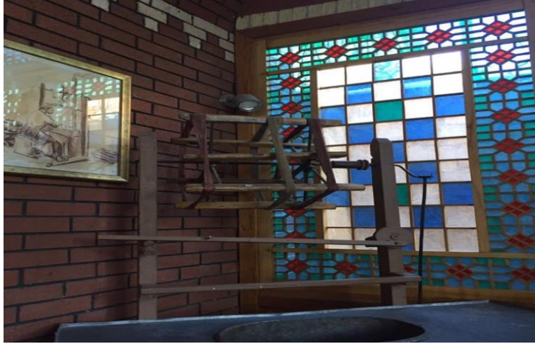
Fotoğraf 3.4 Koza Aan Fabrikası, koza haşlayan kazan ve elle alışan makine (Ordubad Tarih Müzesi)
