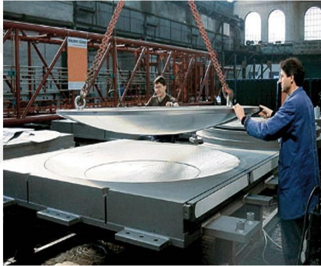
Şekil 4.3: Sürtünmeli sarkaç tipi izolator örneği (Url-3)
