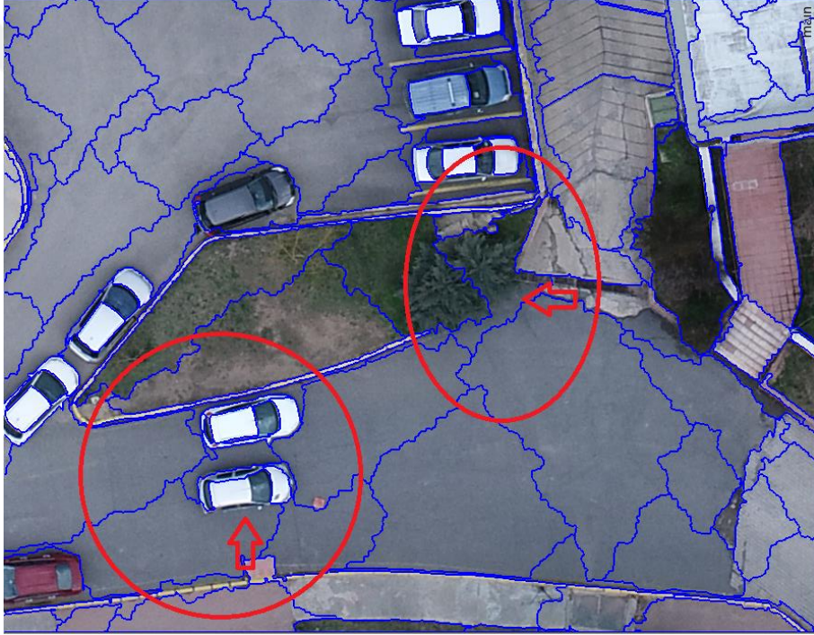
Şekil 5.12 Sınıfların birbiri ile karışması (ölçek: 80 – şekil: 0.8 – Bütünlük: 0.2 seçilmiştir).
