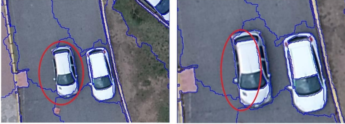
Şekil 5.14 eCognition yazılımında segmentlerin elle düzeltilmesi.
