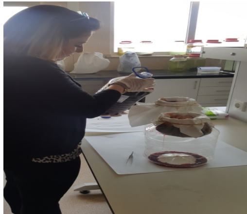
Resim 3.3 Mezbaha atık suyunun kaba filtreleme işlemi
