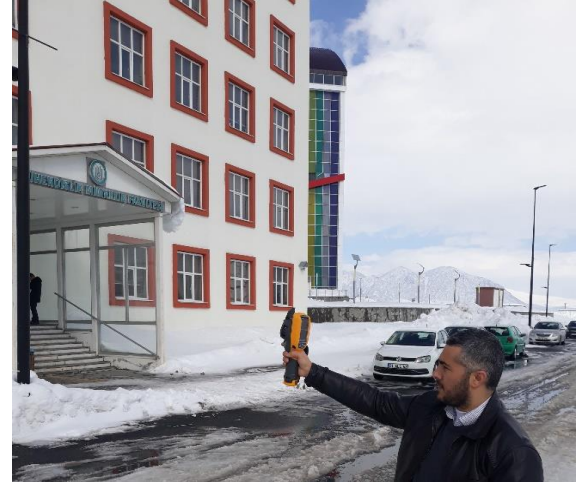
Şekil 2.2. Termal kamera ile görüntü elde edilmesi
