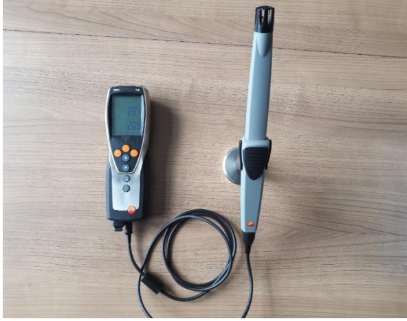
Şekil 2.3. Testo 435 cihazı ile IAQ probu
