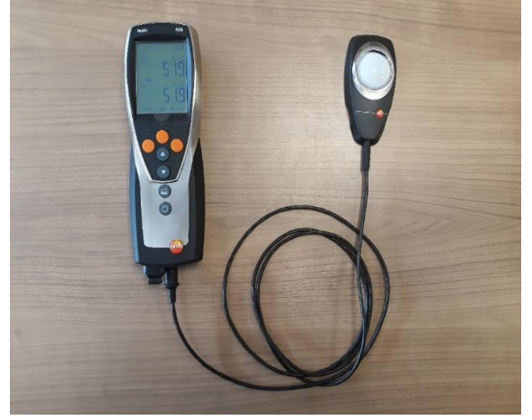
Şekil 2.4. Testo 435 cihazı ile Luxprobu
