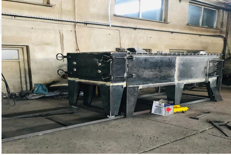
Resim 4.22 Isıl işlem fırını montaj resmi-4.
