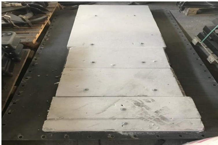
Resim 4.11 Isıl işlem fırını tavanı montaj resmi.
