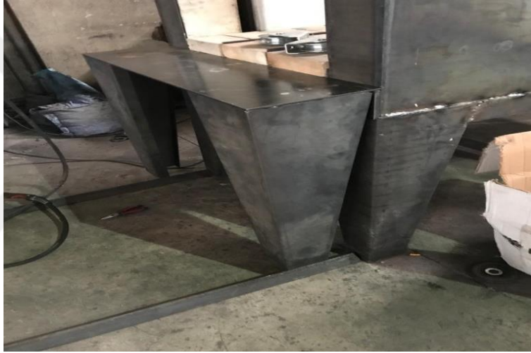
Resim 4.13 Isıl işlem fırını yürüyen taban montaj resmi-2.
