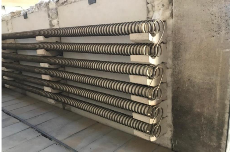
Resim 4.18 Isıl işlem fırını rezistans teli, rezistans borusu ve rezistans askı tuğlası montaj resmi.
