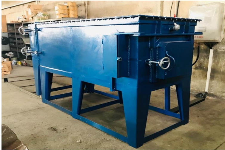
Resim 4.26 Isıl işlem fırını montaj resmi-8.
