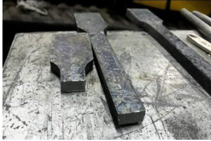
Resim 4.6 Çekme testi sonrası hasara uğrayan örnek numune.
