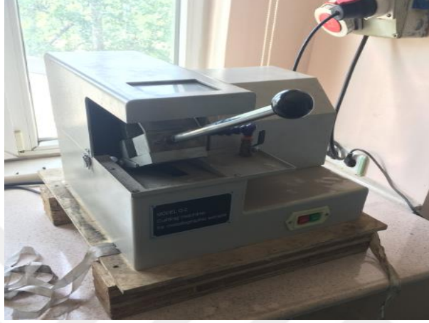
Resim 3.10 Numunelerin kesilmesinde kullanılan Onalkon Model Q-2 metalografi numune kesme cihazı.
