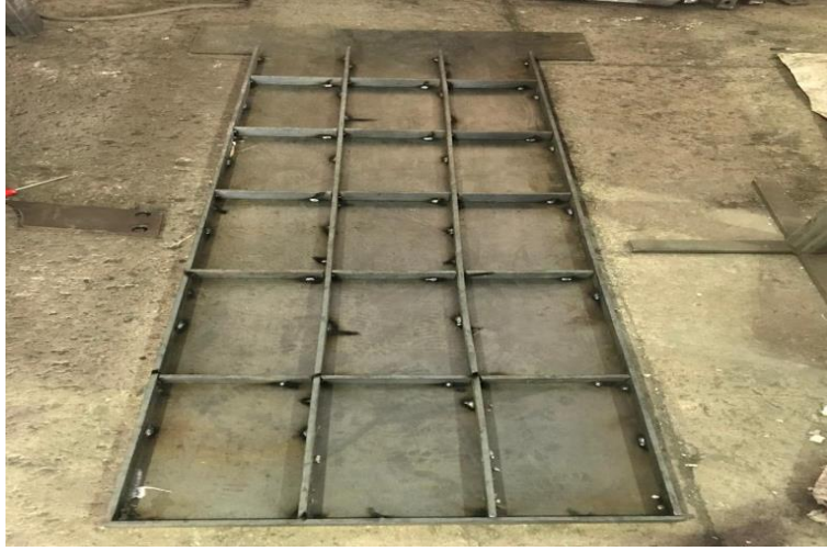
Resim 4.12 Isıl işlem fırını yürüyen tabanı montaj resmi-1.
