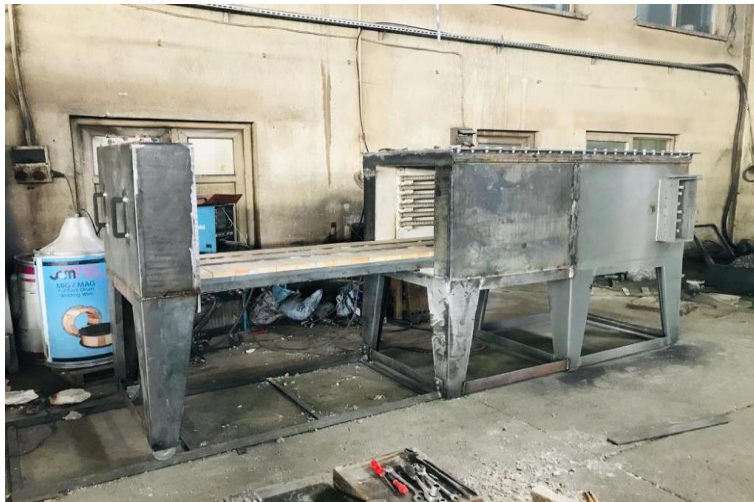
Resim 4.23 Isıl işlem fırını montaj resmi-5.
