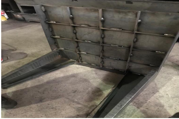
Resim 4.9 Isıl işlem fırını alt tabanı montaj resmi.
