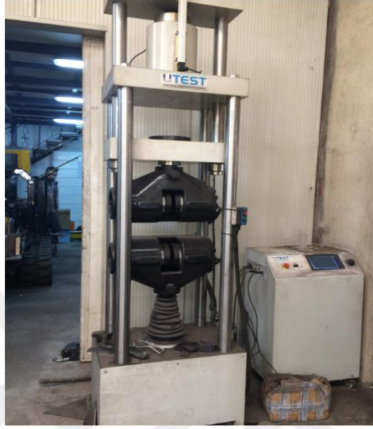
Resim 3.14 Çekme testi deneylerinin yapıldığı Utest marka çekme cihazı.
