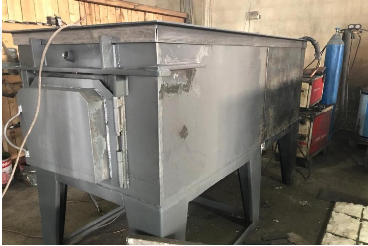
Resim 4.19 Isıl işlem fırını montaj resmi-1.
