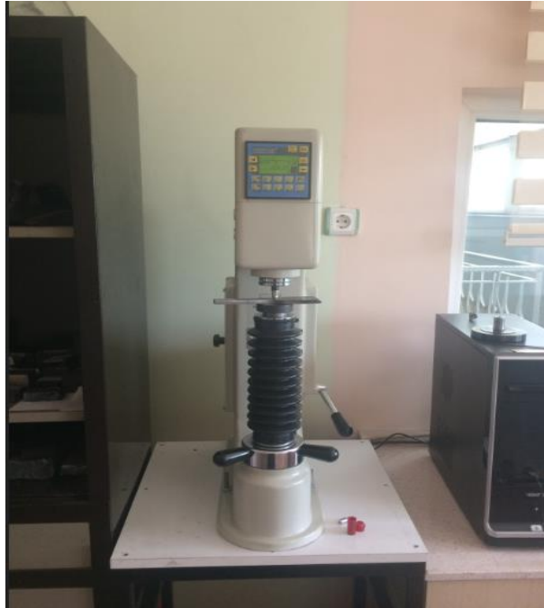
Resim 3.13 Sertlik ölçümlerinde kullanılan Bms Digirock-Rbov marka sertlik ölçüm cihazı.
