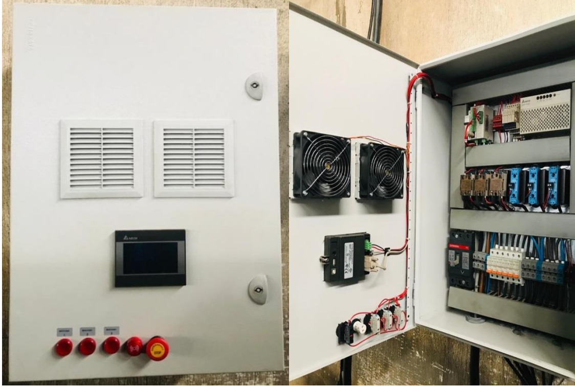
Resim 4.7 Isıl işlem fırını elektrik kumanda panosu.
