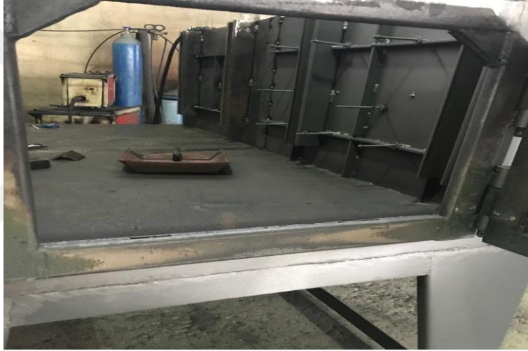
Resim 4.10 Isıl işlem fırını yan duvarı montaj resmi.
