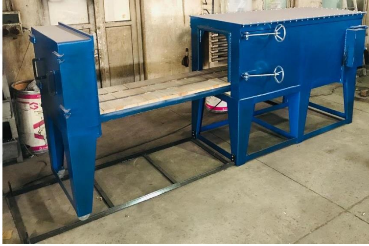
Resim 4.25 Isıl işlem fırını montaj resmi-7.
