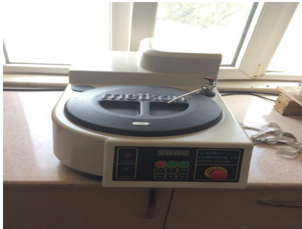
Resim 3.11 Numune zımparalama ve yüzey parlatma işlemlerinde kullanılan Metkon Forcipol marka parlatma cihazı.
