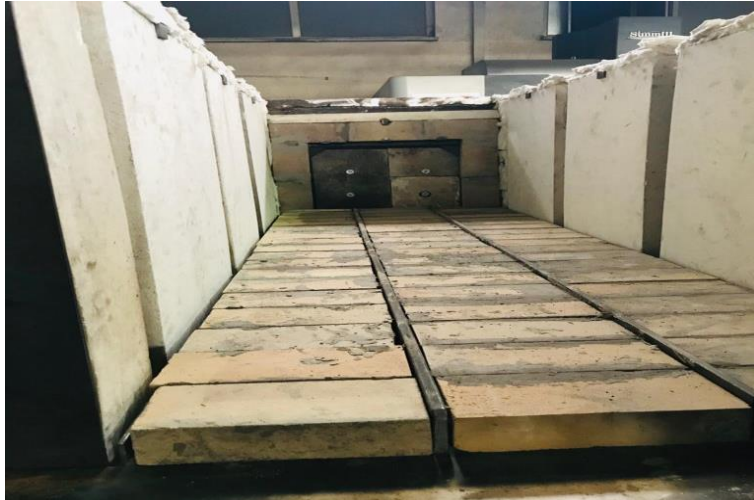
Resim 4.17 Isıl işlem fırını ateş tuğlası montaj resmi.
