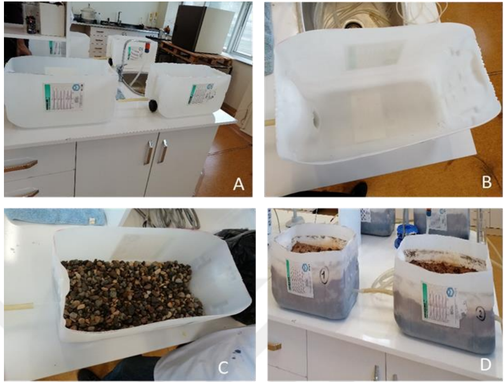
Şekil 3.1. Kontrol reaktörünün yapım aşamasındaki görseller
