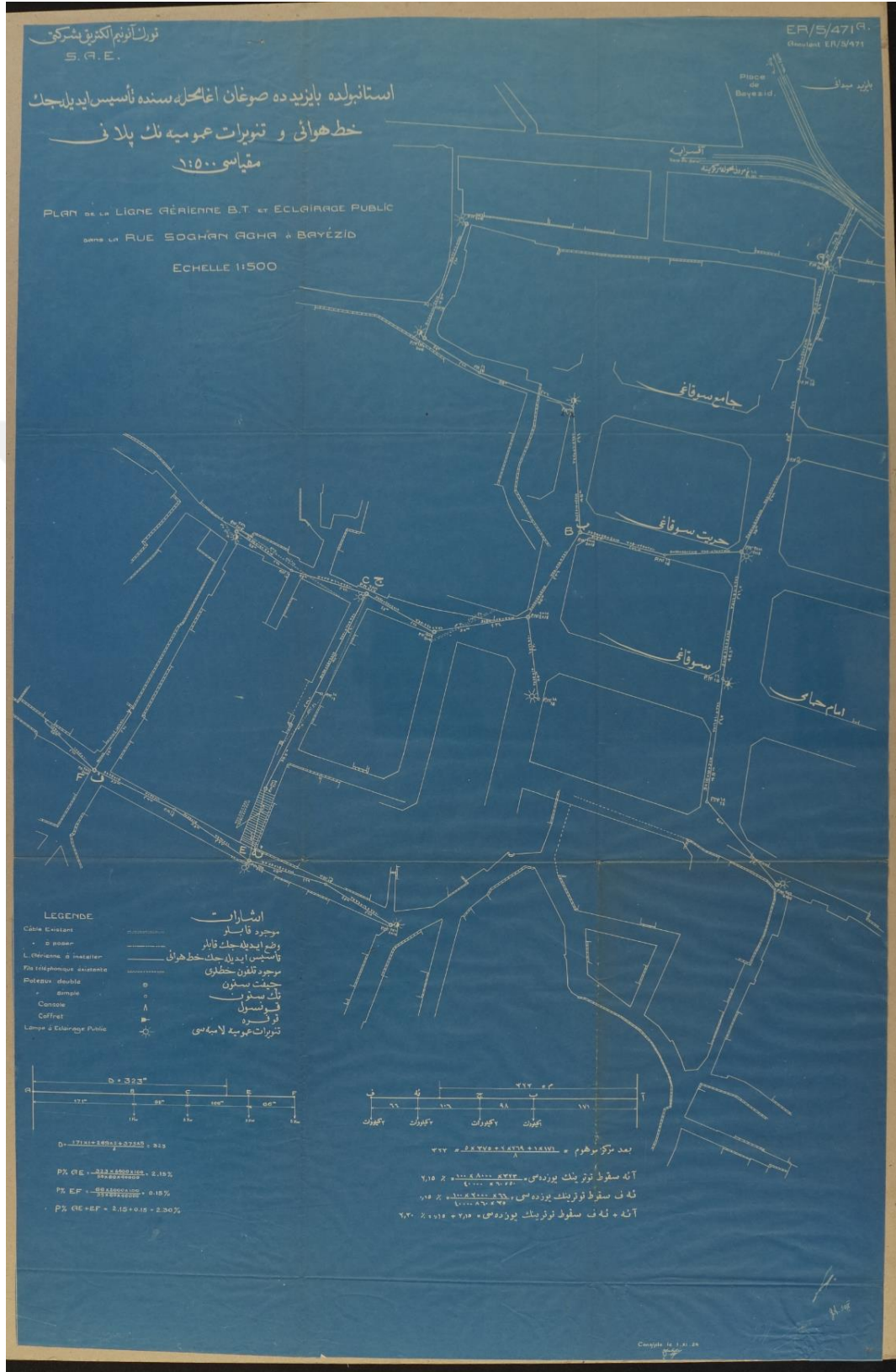
Ek 2. Beyazıt Soğanağa mahallesinde 1924 yılında tesis edilen hava-i hat ve umumi aydınlatma planı.
