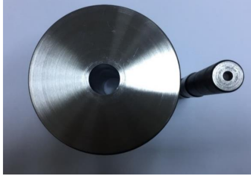
Şekil 6.4. Sıkıştırılabilirlik deneyleri için kullanılan kalıp
