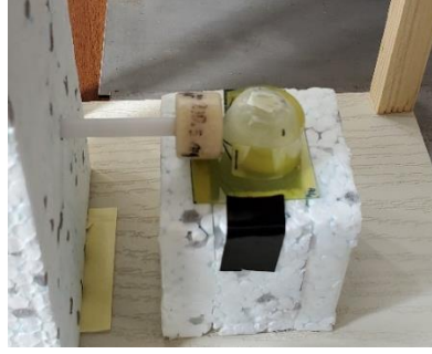
Şekil 4.25 Disk kaynak göz lensi hizasında oluşturulan ölçüm düzeneği
