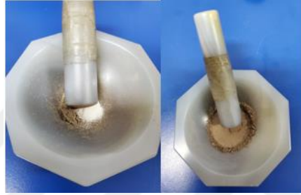
Şekil 3.1 Praseodim oksit ve selüloz bağlayıcı karışımı
