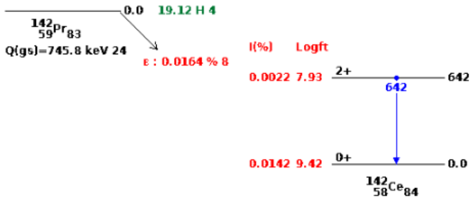
Şekil 2.4 ^{142}\text{Pr} 'nin ^{142}\text{Ce} 'ye bozunma şeması (NNDC, 2020b)
