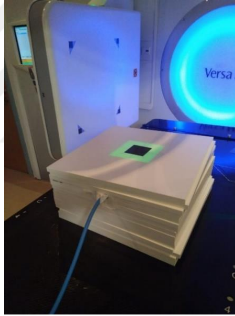
Şekil 3.7 EBT3 film kalibrasyonunun 6 MV enerji ile yapılmasında kullanılan iyon odası ölçüm düzeneği
