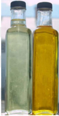
Şekil 2.3 Ağartma sonrası ve öncesi kanola yağı (Anonymous 2013a)
