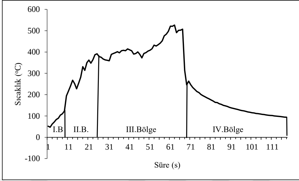
Şekil 6.25. %10-30-60 TiC takviyeli kaplamanın 1.katmanının sıcaklık-zaman grafiği
