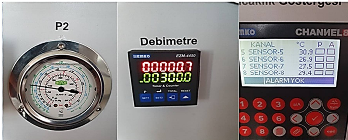
Resim 3.17. Deney setindeki ölçüm cihazları
