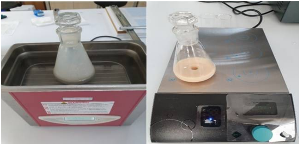
Resim 3.11. Hazırlanan nanoyağlayıcının karıştırılması
