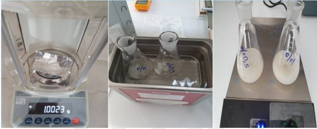
Resim 3.12. POE/ \text{Al}_2\text{O}_3 /TX-100 şeklinde hazırlanan nanoyağlayıcının karıştırılması
