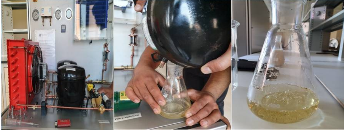
Resim 3.8. Kompresör yağının boşaltılması
