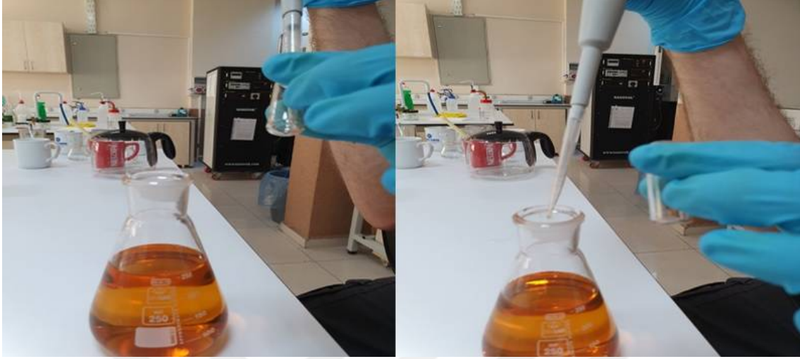
Resim 3.10. Yüzey aktif malzemenin eklenmesi
