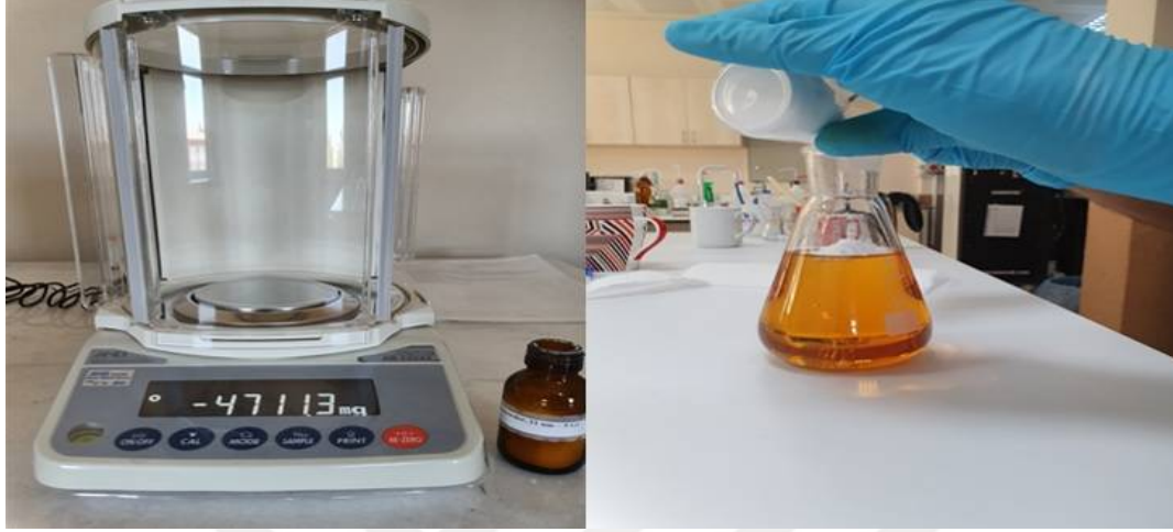
Resim 3.9. POE içerisine nanopartiküllerin eklenmesi
