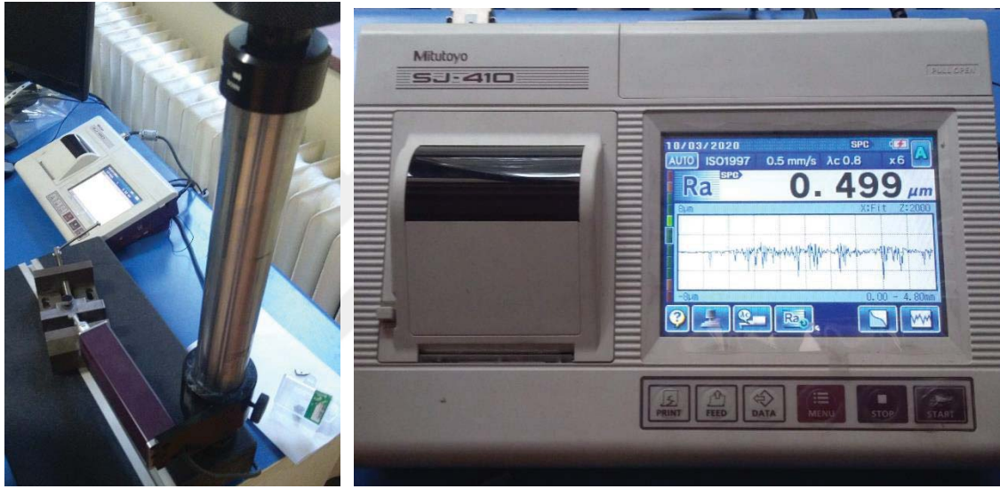
Resim 6. 2. Yüzey pürüzlülük ölçüm cihazı (Mitutoyo SJ-410)
