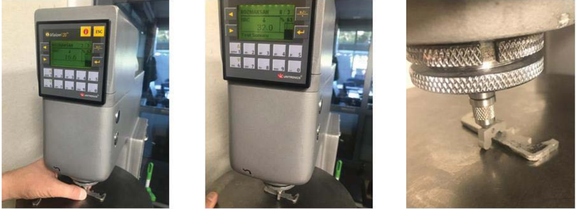
Resim 6.1. Tek kat eloksall kaplı hilal palet, ift kat eloksall kaplı hilal palet sertlik lmleri ve lm dzeneęi
