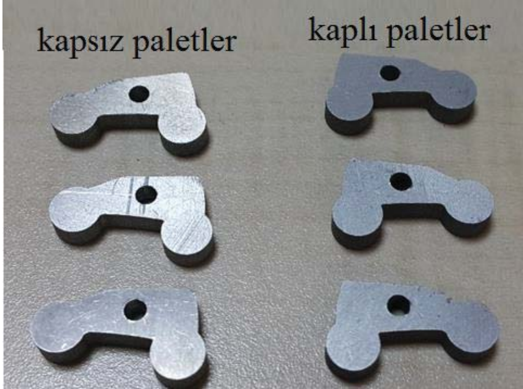
Resim 5. 4. Eloksal ile kaplanmamış ve kaplanmış AL5083 hilal paletler
