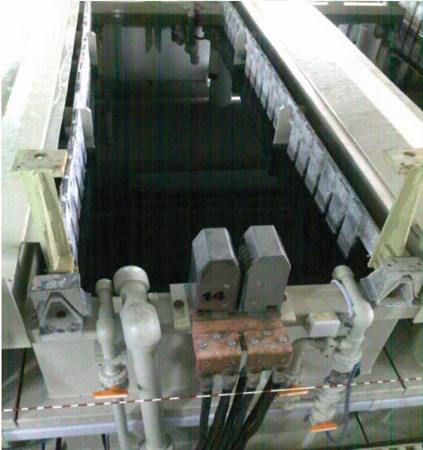
Resim 5. 2. Eloksal kaplama havuzunun görünümü
