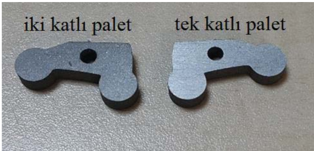
Resim 5. 3. Farklı anodizasyon süresine tabi tutulmuş AL5083 hilal paletler
