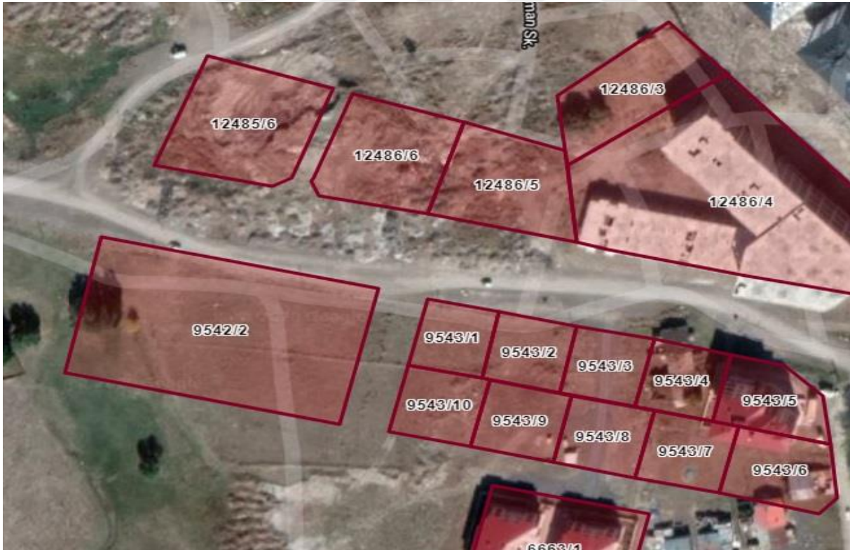
Şekil 2.6 İlk uygulama sonucu oluşan imar parseli ile ikinci bir uygulamada DOP kesilemeyen parselleri gösterir kroki örneği.
