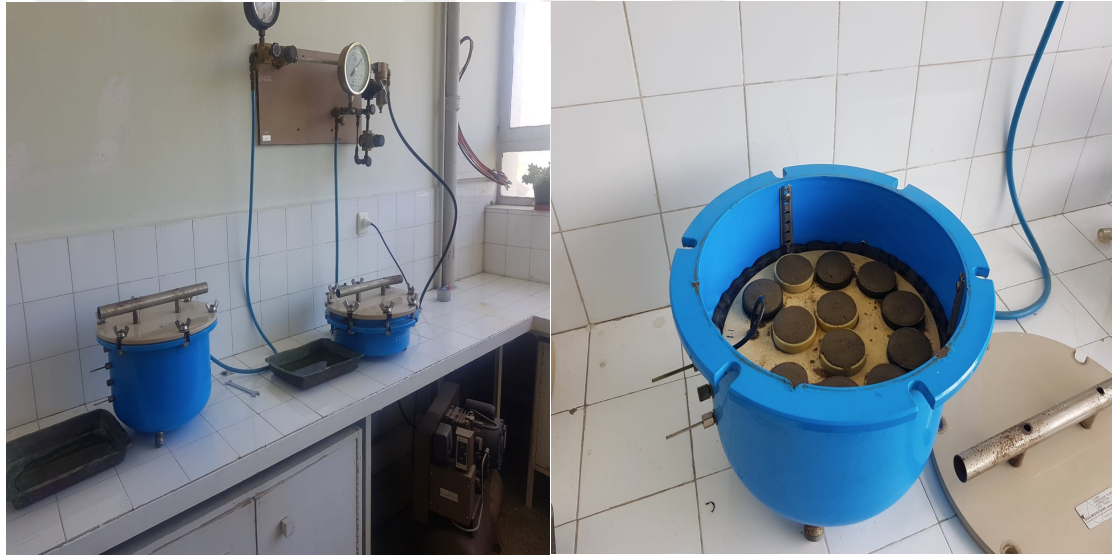
Resim 3 . 8: Tarla Kapasitesi analiz Aleti
