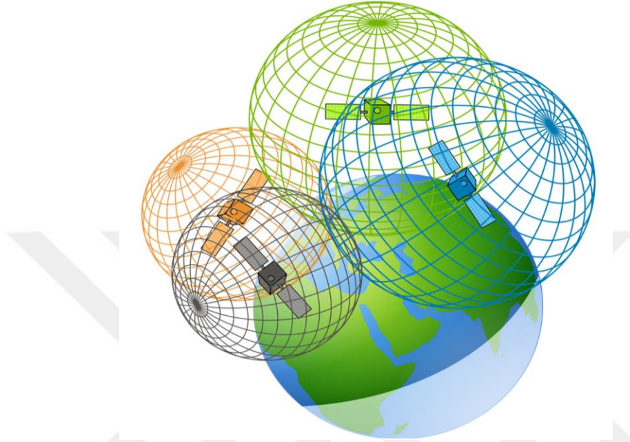
Şekil 1-6. Trilaterasyon yöntemi ile 4 uydunun küresel kesişmesinden konum elde etme gösterimi [9]
