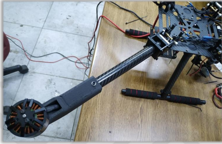
Şekil 2-31. Motorların kollara montajı
