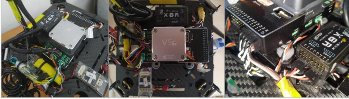
Şekil 2-34. Üst kontrol katının montajı
