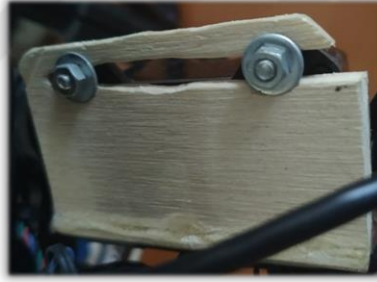
Şekil 2-37. Balsa ile üretilen parça
