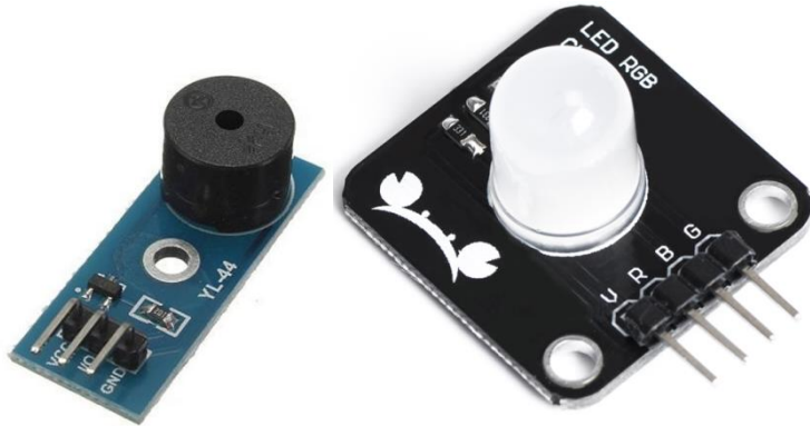
Şekil 8. Akıllı barete takılan cihazda kullanılan buzzer ve led. a) Buzzer, b) RGB led
