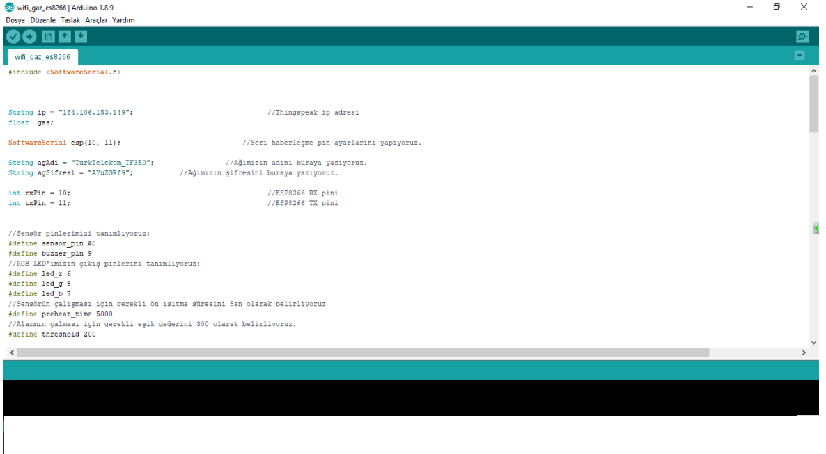
Şekil 12. Pin tanımları için yazılan kodlar.
